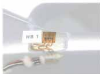
应变计的应用与校准，例如，符合VDI/VDE 2646规范
