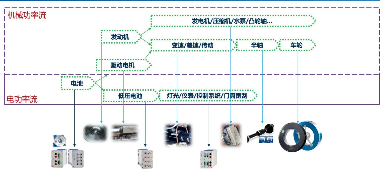
随着现代车辆的不断发展，能量流测试的地位正在变得愈来愈重要：制造商和供应商需要全面了解车型电耗的分布情况，从而大幅减少验证的周期和成本；定量地找到样车与标杆车型之间的能量消耗差异，然后确定改善电耗水平的最佳着手点。此外，还需要根据能量流测试得到的相关数据，搭建、校准整车仿真模型，以便制定不同的改进措施，提高整车的能源利用效率。
