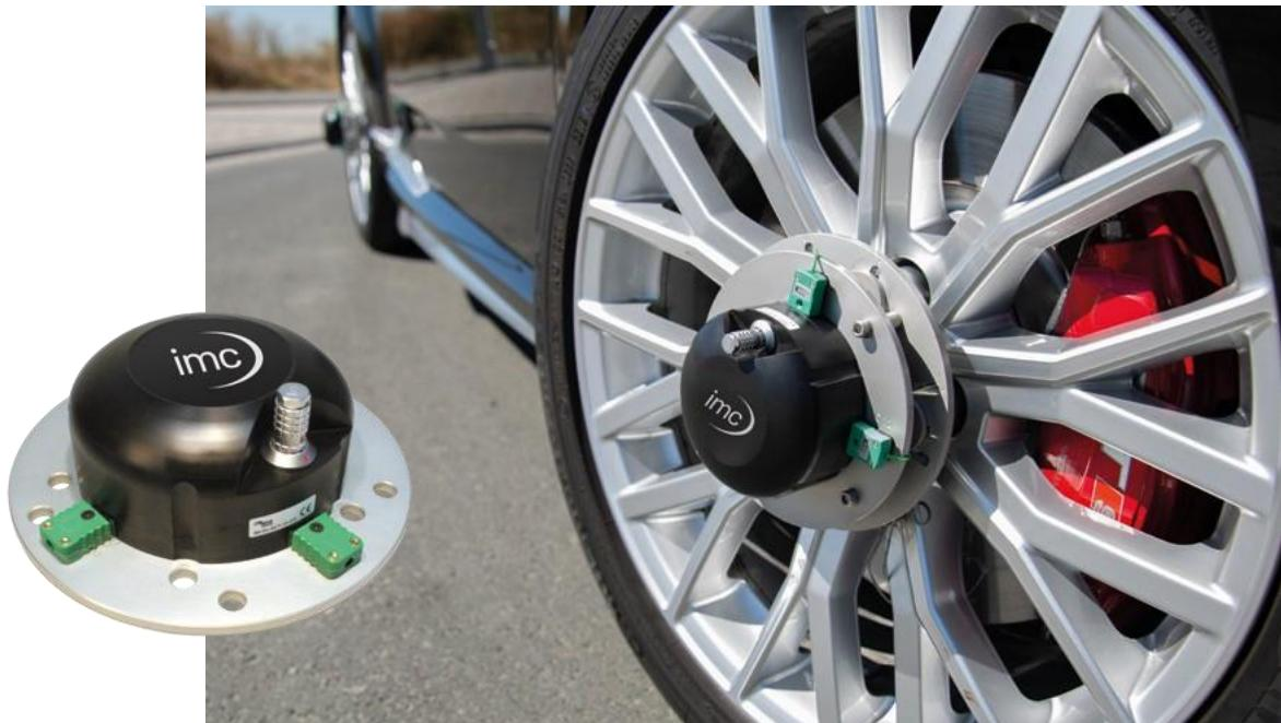
D<sup>x</sup>-BrakeTemp 是一款用于测量公路车辆车轮温度的高精度工具。所有测量信号（例如制动盘的温度）均直接在车轮上进行数字化，并通过车镜天线以遥测方式传输至车内的接收器单元。凭借其稳健的设计，该系统也非常适合恶劣环境和道路驾驶。
