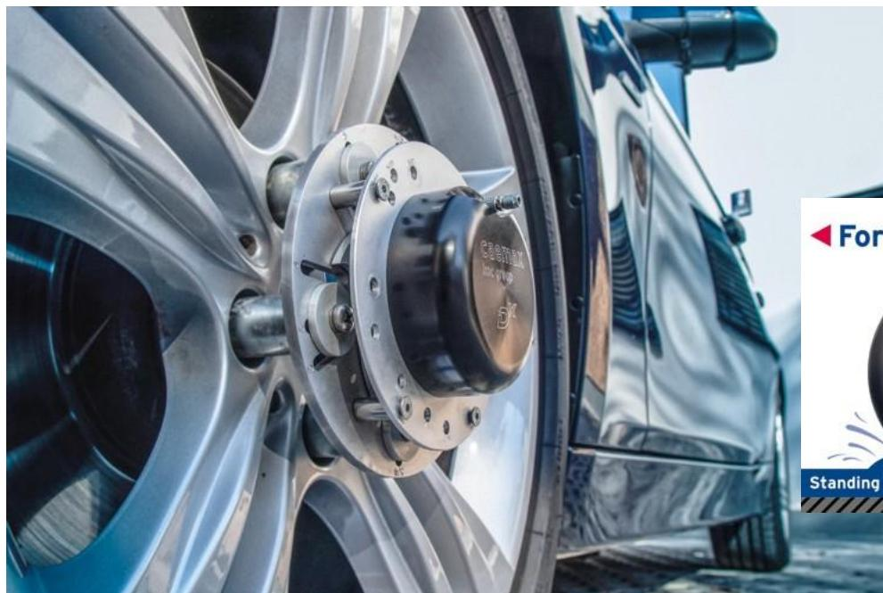
D<sup>x</sup>-Speed 系统可以方便地直接获取车轮上的车轮速度。该系统不需要定子或额外的参考点，即使在泥、雪和灰尘等恶劣条件下，也可以在测试台上和室外提供测量结果。准确度通常优于 0.5%。对轴的冲击也不会影响结果。这意味着即使在崎岖不平的道路上行驶也是可能的！
