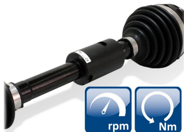
图1: 轴上应变计处安装的半壳试外壳机械功率测量系统，内置 D x 发射器单元和转速传感器。
