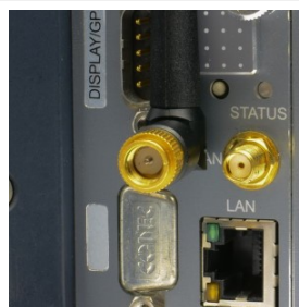
WLAN - Antenne mit SMA (männlich) Anschluss am Gerät SMA (weiblich)
