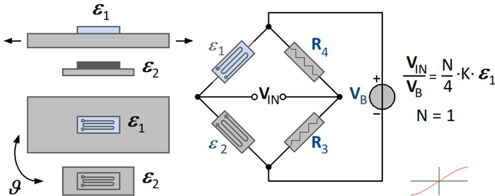
Die Schaltung verwendet zwei DMS. Der erste DMS befindet sich auf dem Messobjekt, der zweite auf gleichem Material in gleicher Umgebungstemperatur. Er hat die Aufgabe der Temperaturkompensation. Die Dehnung ergibt sich zu:
