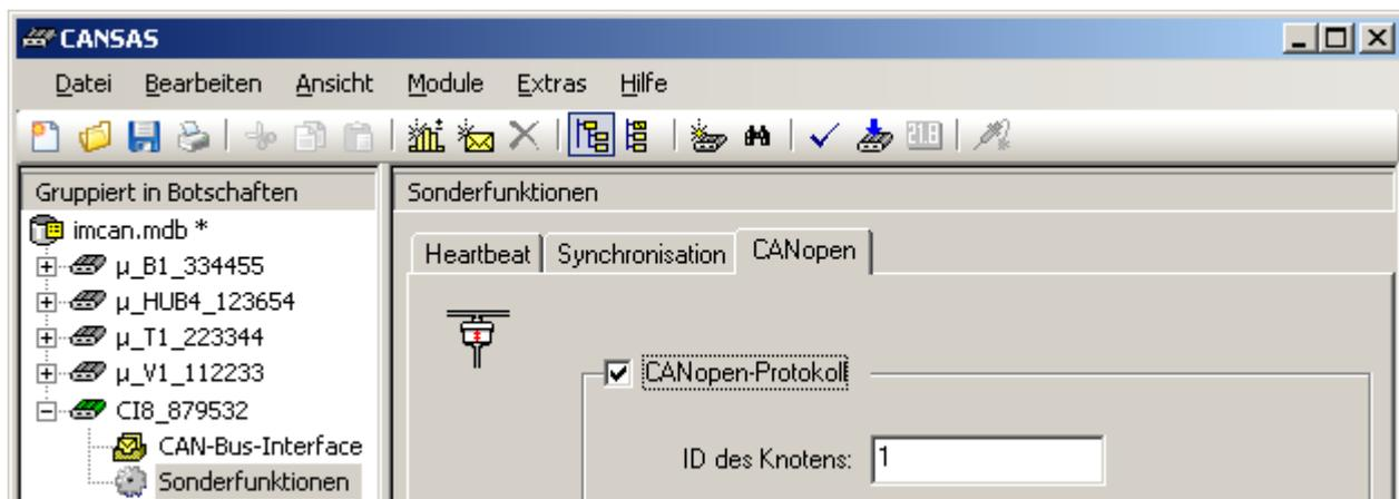
Die CANopen-Einstellung wird bei Einstellung "[Rücklesbare Konfiguration](#)<sup>111</sup> = EIN" fest im Modul vermerkt, so dass dies auch nach Neuaufnahme solcher Module zur Verfügung steht.
