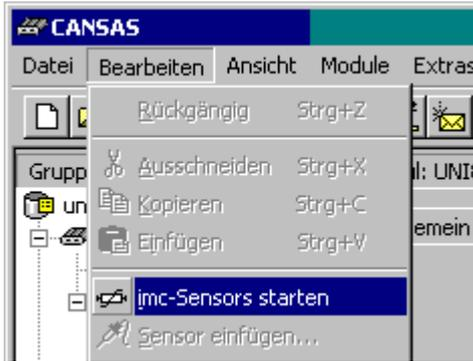
Ist *imc SENSORS* installiert, kann die Sensor-Datenbank mit dem Menü "Bearbeiten" > "imc SENSORS starten" oder durch Auswahl des Schaltfläche in der Werkzeugleiste gestartet werden.
