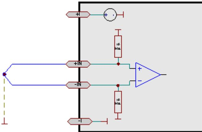
Thermoelement (potentialfrei und extern potentialbezogen durch Punktschweißverbindung)
