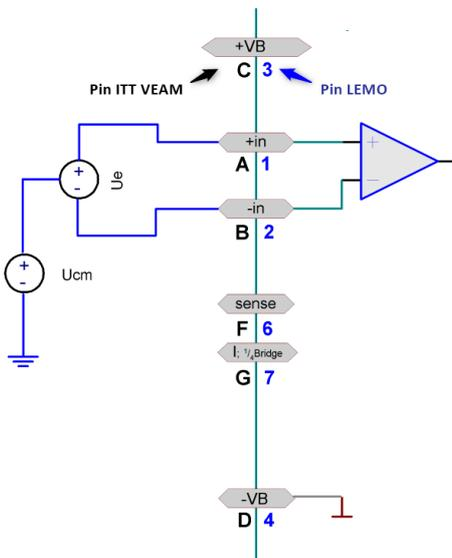
Die Gleichtaktspannung  $U_{cm}$  muss im Bereich von  $\pm 10$  V liegen. Diese verringert sich um die halbe Eingangsspannung.
