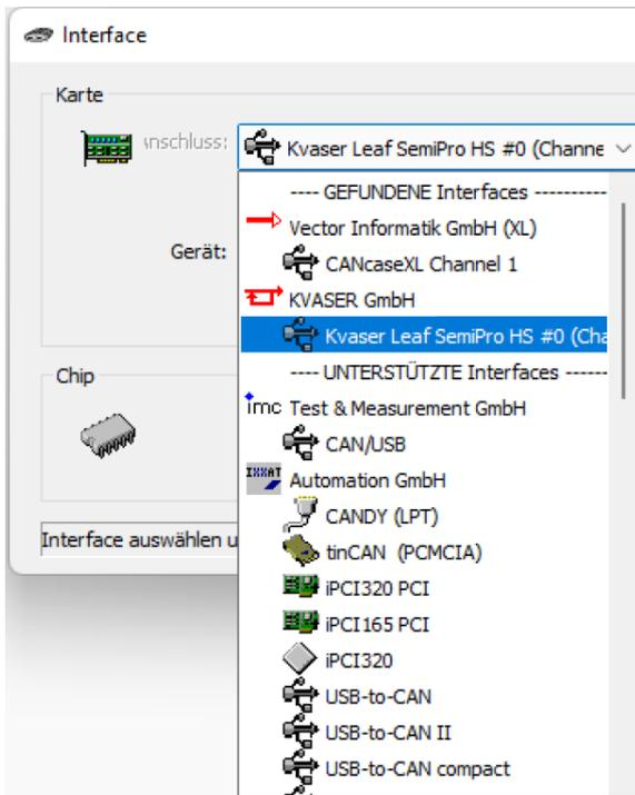
Von der imc CANSAS Software werden verschiedene Anschlusskarten z.B. der Firmen Vector, PEAK, Kvaser, XXAT und HORIBA unterstützt. Eine Auswahl an Treibern befindet sich im Installationsverzeichnis unter *\Driver*. Die jeweiligen Unterverzeichnisse sind gegebenenfalls weiter unterteilt in die verschiedenen Interfacetypen.
