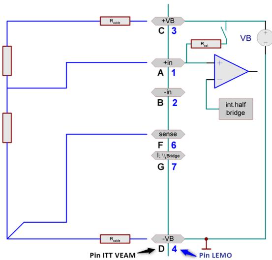
Sie haben nur eine Halbbrücke. Das können z.B. zwei zusammen geschaltete DMS sein oder ein Sensor, der intern eine Halbbrücke ist, oder ein potentiometrischer Sensor. Die Halbbrücke wird 4-drahtig angeschlossen. Zur Wirkung und Nutzung der Senseleitung SENSE siehe Beschreibung der [Vollbrücke](#) <sup>308</sup>.
