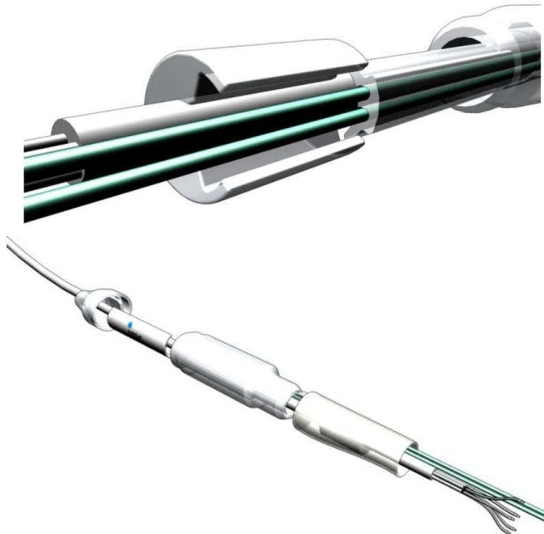
*Den Silikonschlauch über die Anpasshülse und über den Ansatz am Gehäuse ziehen. Abschließend die Anpasshülse im Silikonschlauch justieren.*
