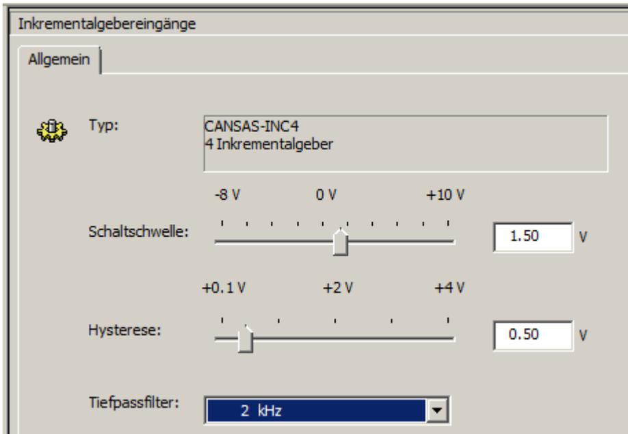
**Die eingestellte Konditionierung gilt global für alle 4 Inkrementalgeber-Kanäle, sowie den Index-Kanal (Nullimpuls) gleichermaßen. Einzige Ausnahme ist, dass der Indexkanal stets ein festes Filter von 20 kHz hat.**
