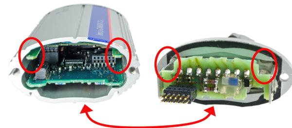
**Schritt 7:** Führen Sie die Gehäusefront vorsichtig in das Gehäuse ein. Beachten Sie dabei unbedingt, dass sich das Gehäuse und die Gehäusefront in korrekter Position zueinander befinden. Erkennbar ist dies an den Führungskanten des Anschlussterminals, die an den schmaleren Führungsleisten im Gehäuse entlang geführt werden müssen (siehe Bilder). Zusätzlich ist die korrekte Position an der dem Gehäuse angepassten Einbuchtung an der Gehäusefront zu erkennen.
