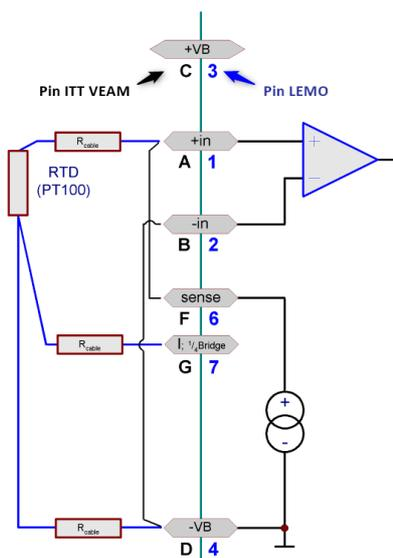
Der PT100 wird über zwei Leitungen (-SENSE und -VB) mit konstantem Strom versorgt. Über eine weitere Leitung (I, 1/4B) wird die Spannung über der Versorgungsleitung erfasst und zur Kompensation der parasitären Spannungsabfälle verwendet. Dabei wird vorausgesetzt, dass die Widerstände der Versorgungsleitungen die gleiche Größe und die gleiche Temperaturdrift haben.
