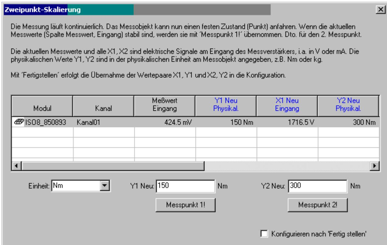
Ist das Feld "Konfigurieren nach 'Fertig stellen' " aktiviert, so erfolgt nach dem Schließen des Dialogs automatisch ein Upload dieser Konfiguration in das Modul.
