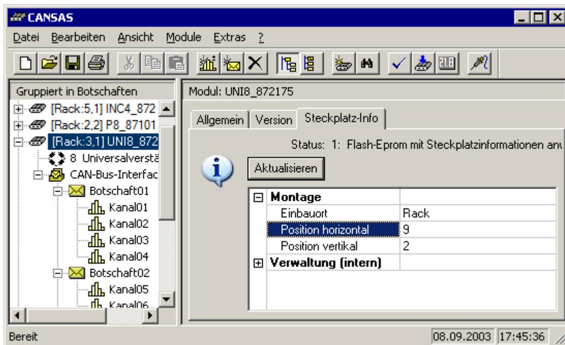
Das Bild zeigt einen typischen Inhalt. Der Inhalt des EPROMs ist vom Anwender überschreibbar. Die horizontale Position ist die Nummer des Steckplatzes innerhalb des Racks, beginnend ganz links mit der 1.
