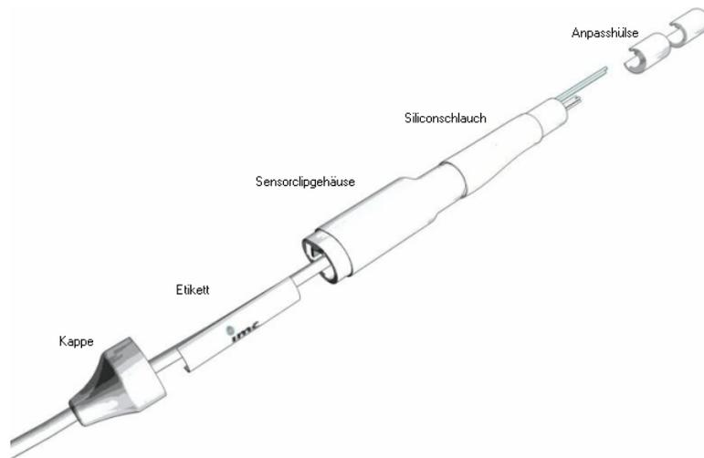
*Alle Teile des Plug & Measure Sensorclips auf das Kabel fädeln*
