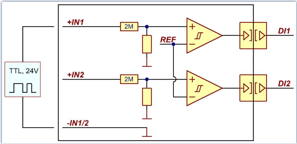
Spannungs-Modus mit TTL (5 V) oder 24 V Logik-Pegel
