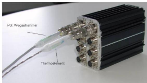
Bild 2: Universalmessgerät mit angeschlossenen Sensoren und Sensorclip
