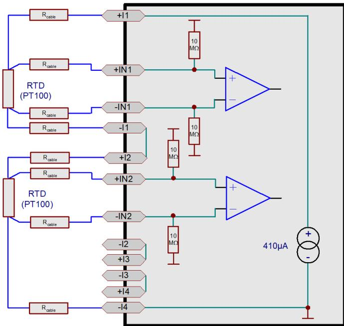
Neben Thermoelementen können **PT100** direkt in **4-Leiter-Konfiguration** angeschlossen werden. Eine extra Referenzstromquelle speist gemeinsam eine Kette von bis zu vier in Reihe geschalteten Sensoren.
