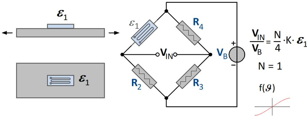
Diese DMS-Schaltung verwendet einen **aktiven** DMS, der sich im uniaxialen Spannungsfeld auf dem Messobjekt befindet. Dieser DMS wird durch drei passive Widerstände im Modul zur Vollbrücke ergänzt. Der DMS kann einen Widerstandswert von 120 Ω haben.
