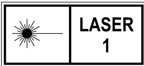
Das CANFDX/FBG-T8 Gerät arbeitet mit Laser der Klasse 1. Das bedeutet, dass das Gerät während des Normalbetriebs sicher ist. Der direkte Blick in den Strahl der Lasereinrichtung der Klasse 1 kann trotzdem eine irritierende Wirkung auf das Sehvermögen erzeugen. Dies ist z.B. möglich, wenn die Schutzabdeckung entfernt ist oder eine Beschädigung des Gerätes vorliegt.
