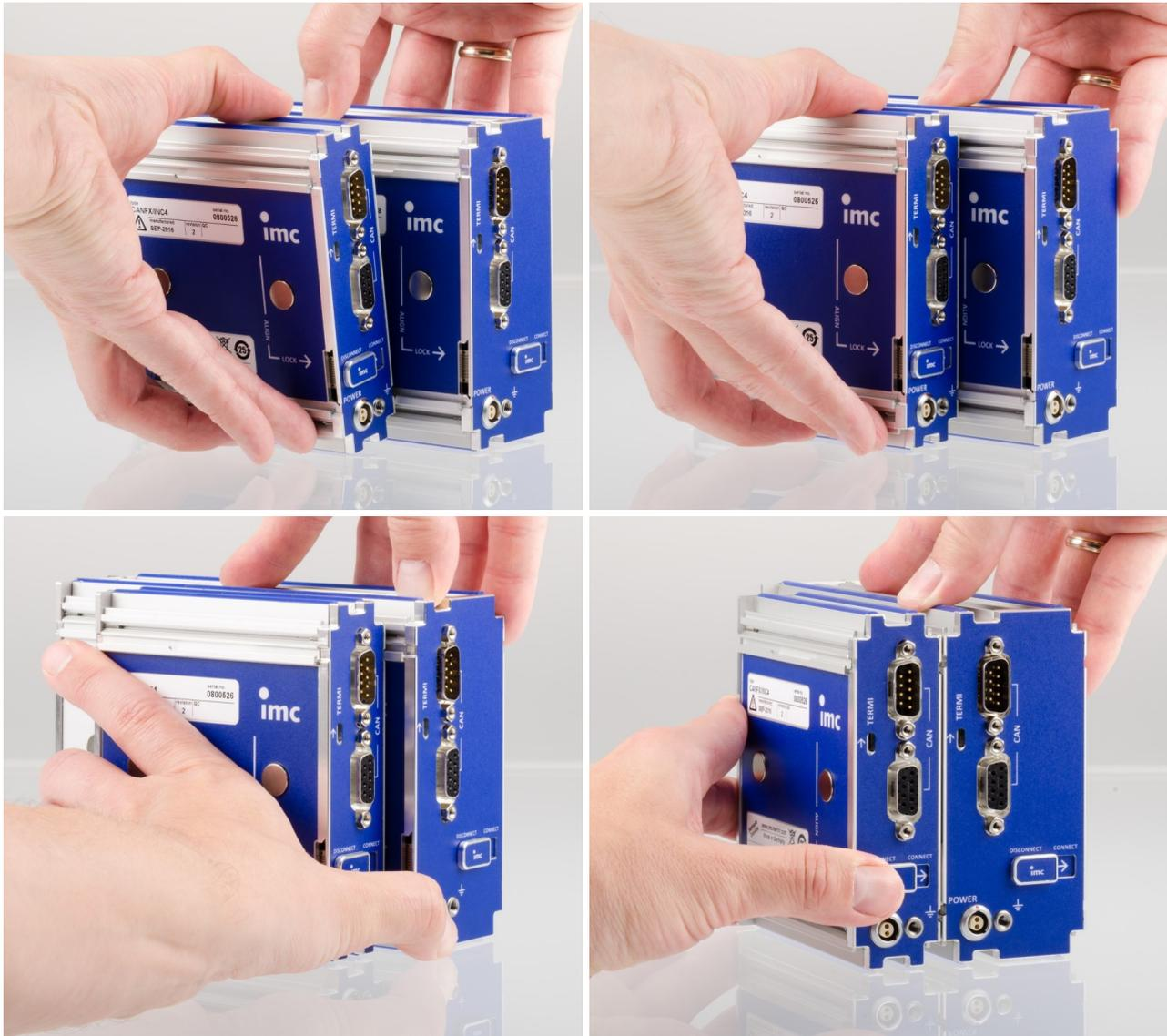
2. Um die Module miteinander koppeln zu können, muss die Rückseite bündig abschließen.
