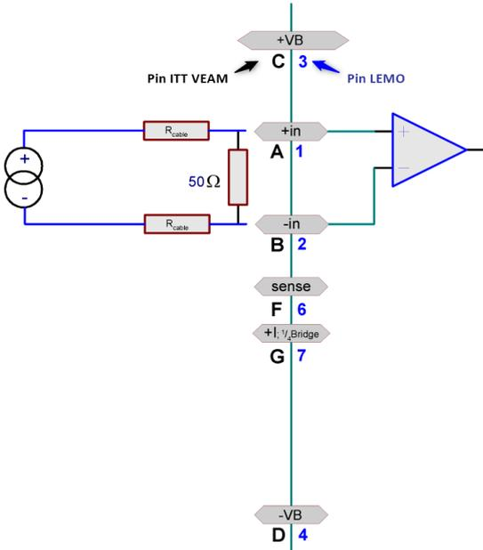
Der ACC/DSUBM-12 gehört nicht zum Standardlieferungsumfang des Verstärkers und enthält einen 50 Ω Bürdenwiderstand. Darüber hinaus kann auch über eine extern angeschlossenen Bürde Spannung gemessen werden. Eine entsprechende Skalierung ist in der Oberfläche einzutragen. Der Wert von 50 Ω ist nur ein Vorschlag. Der Widerstand sollte ausreichend genau sein. Bitte beachten Sie die Leistungsaufnahme im Bürdenwiderstand.
