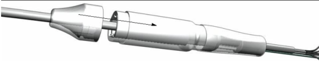
*Das beschriftete Etikett in das Gehäuse einschieben und die Kappe aufstecken.*
