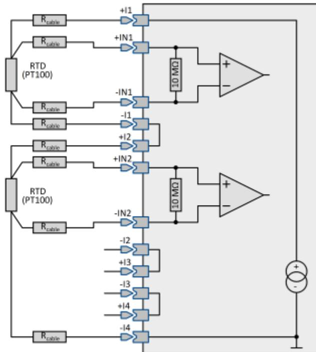
Beispiel: Anschlusskonfiguration für zwei PT100 mit ACC/DSUBM-T4
