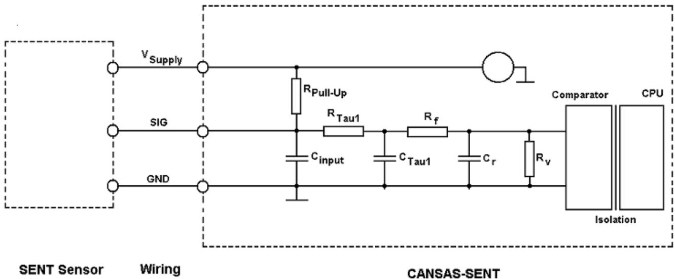
Der Sensor wird mit dem CANSAS-Modul über die drei Leitungen GND (Masse), SIG (Signalausgang des Sensors) und  $V_{Supply}$  (Versorgungsspannung) verbunden. CANSAS stellt damit auch die Versorgungsspannung des Sensors zur Verfügung.  $V_{Supply}$  ist ein Ausgang des CANSAS-SENT Moduls, SIG ist ein Eingang des CANSAS-SENT Moduls. GND ist die nur für diesen Sensor geltende Masse (Bezugspotential) für die Versorgungsspannung  $V_{Supply}$  und die Signalleitung SIG.
