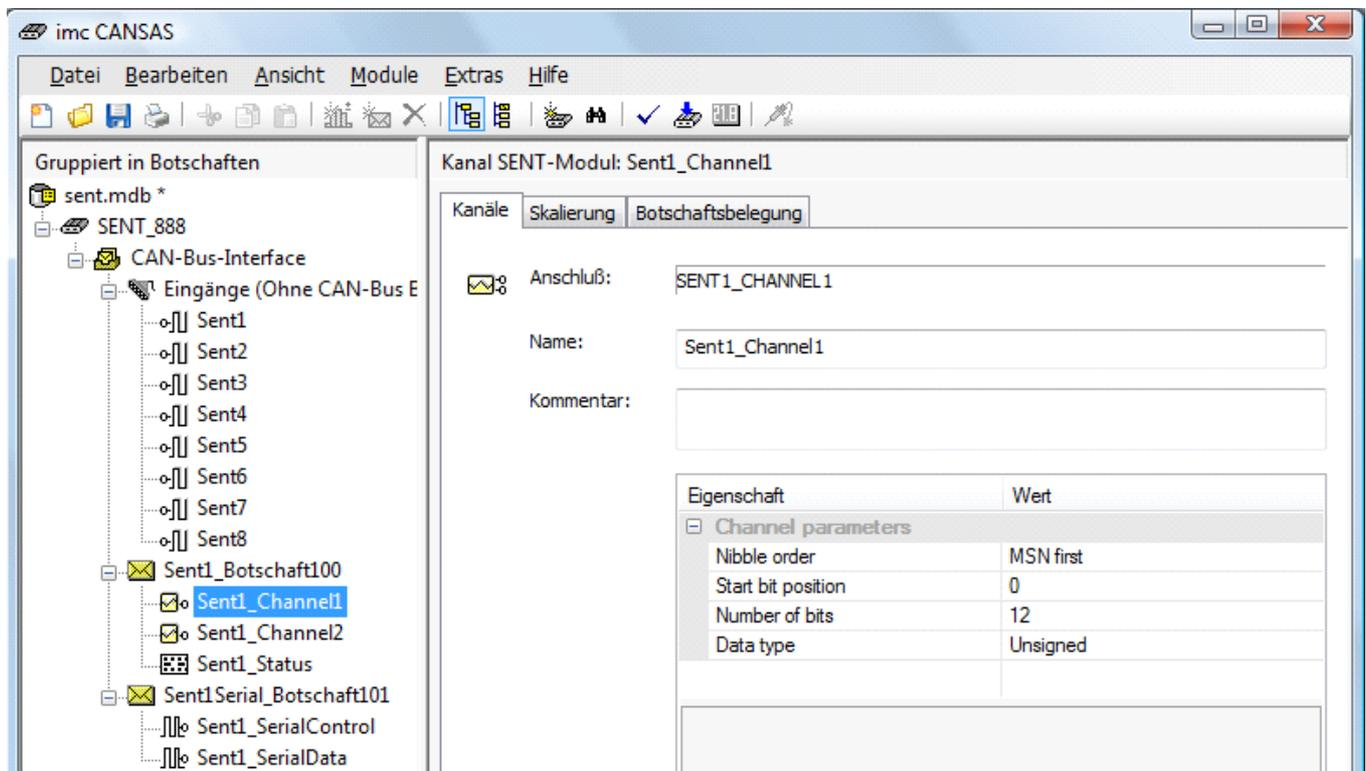
Der FAST-Kanal wird gebildet, indem aus den data nibbles einer SENT-Nachricht eine Zahl extrahiert wird, die in eine CAN-Botschaft gelegt wird.
