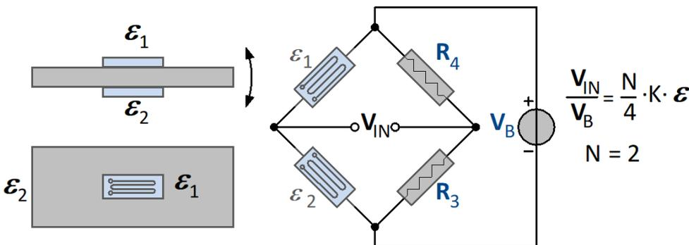
Zwei aktive DMS sind unter gleicher Dehnung mit entgegengesetztem Vorzeichen angeordnet, d.h. ein DMS ist unter Druck und der andere unter gleichem Zug (**Biegebalkenschaltung**). Die Anordnung verdoppelt die Empfindlichkeit für das Biegemoment. Dagegen sind Längskraft, Drehmoment und Temperatur kompensiert. Die Dehnung ergibt sich zu:
