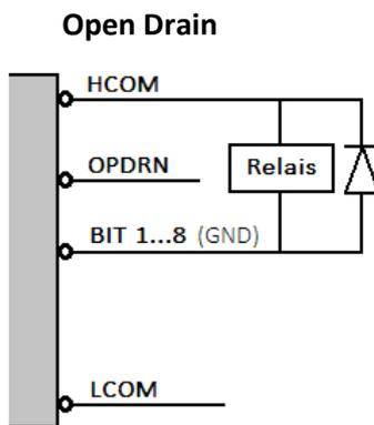
**Gerät aus:** kein Durchgang / hochohmig
