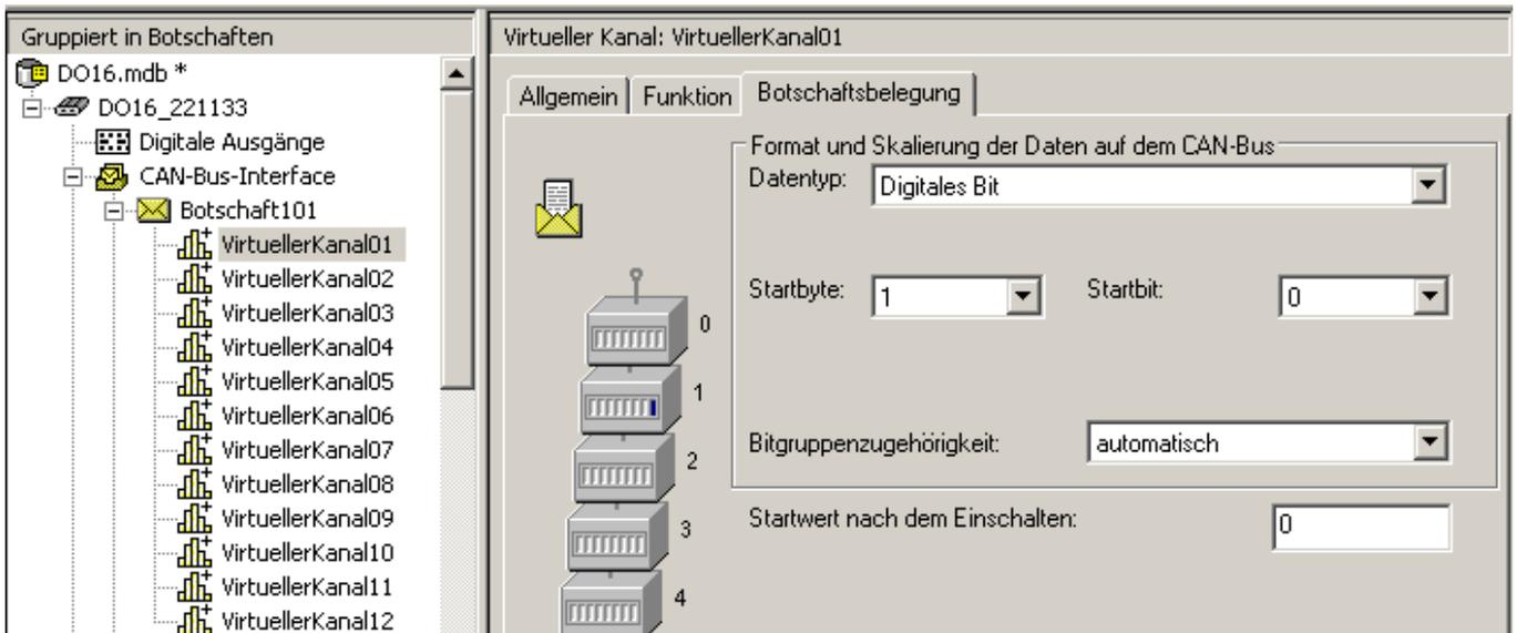
4. Die Einstellungen der digitalen Ausgangsbits im Ordner *Ohne CAN-Bus Botschaft* müssen so angepasst werden, dass dem Ausgangsbit 1 unter der Registerkarte *Funktion* die Funktion *Logisches Nicht* und als Eingangskanal *virtuellerKanal01* zugewiesen wird. Entsprechend muss mit den restlichen 15 Kanälen verfahren werden.
