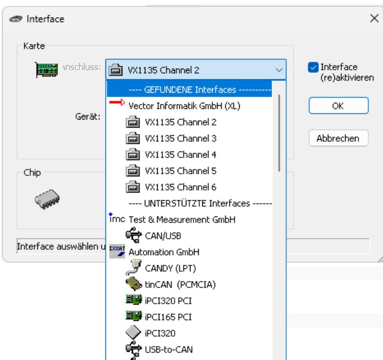
In der imc CANSAS Software, können Sie nun die Kanäle des VX1135 Geräts unter "GEFUNDENE Interfaces" auswählen.
