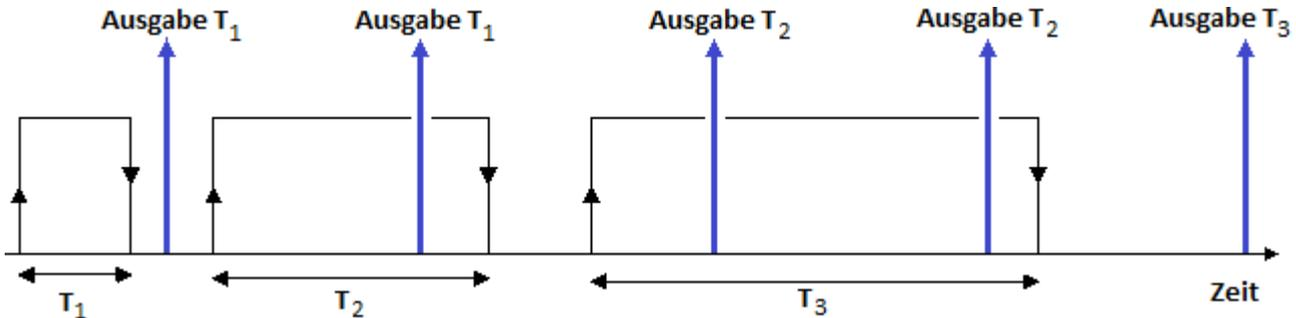
Dargestellt ist eine Zeitmessung, deren Start durch eine positive Flanke im Signal gestartet und durch eine negative Flanke gestoppt wird. Die senkrecht nach oben weisenden Pfeile entsprechen der Ausgabezeit, mit dem zu diesem Zeitpunkt gültigen Ergebnis. Dabei wird zwei Mal  $T_1$ , zwei Mal  $T_2$  und ein Mal  $T_3$  ausgegeben.
