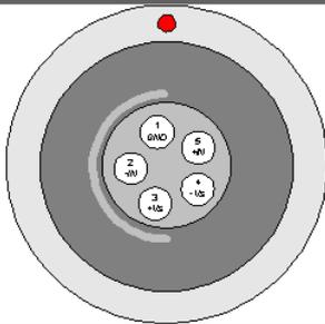
Der Anschluss der Messeingänge sollte mit geschirmtem Kabel erfolgen, wobei positiver und negativer Messeingang (+IN und -IN) innerhalb des Schirms geführt werden. Der Schirm ist mit dem Steckergehäuse zu verbinden.
