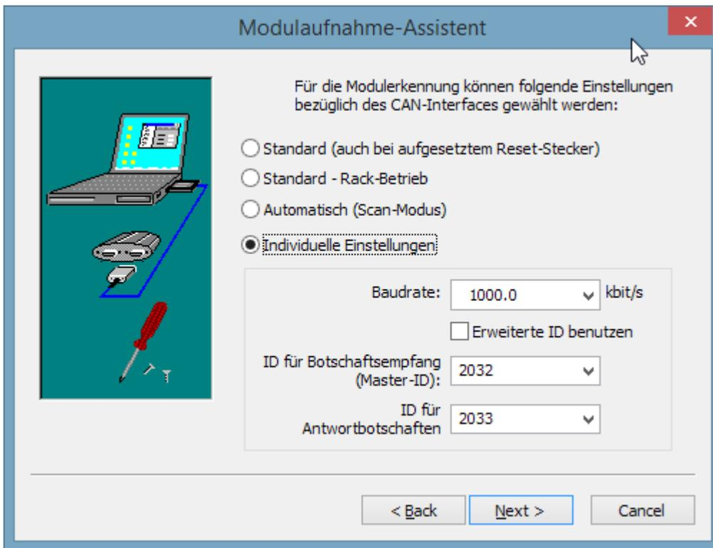
**Standard – Rack Betrieb:** Wie Standard, jedoch vorbereitet für Module, die in ein Rack eingebaut sind. Diese können wegen der kurzen Leitungslänge mit höherer Baudrate betrieben werden. Voreinstellung ist 500 kBit/s, Empfangs-ID = 2 ,Sende-ID= 3
