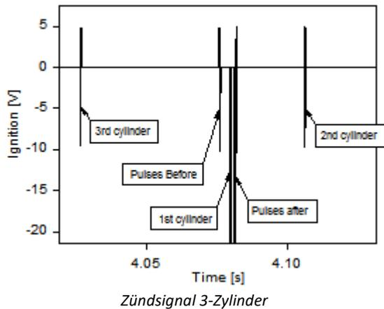
Die Zündzange ist so angeschlossen, dass sie die Zündleitung des 1. Zylinders umschließt. Die Signale der übrigen Zylinder werden aber eingekoppelt, ebenso wie Pulse vor und nach der eigentlichen Zündung.
