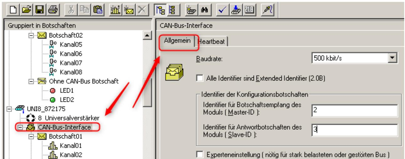
12. Anschließend muss das Modul konfiguriert werden -> Menü *Module /Konfigurieren...*
