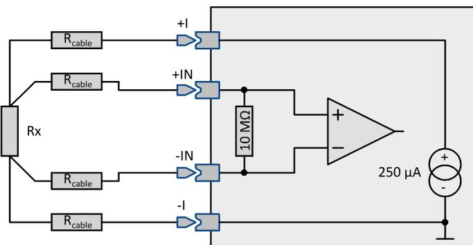
Es gibt für die Widerstandsmessung vier Bereiche: 0  $\Omega$  bis 1000  $\Omega$ , 500  $\Omega$ , 250  $\Omega$  und 150  $\Omega$ . Die Messung erfolgt in Vierleitertechnik. Der Widerstand wird dabei über zwei Leitungen versorgt (+I, -I). Die beiden Messeingänge (+IN, -IN) dienen als Sense-Leitungen. Durch Benutzung dieser Sense-Leitungen kann die Spannung am Widerstand präzise ermittelt werden. Der Spannungsabfall entlang des stromführenden Kabels verursacht keinen Messfehler.
