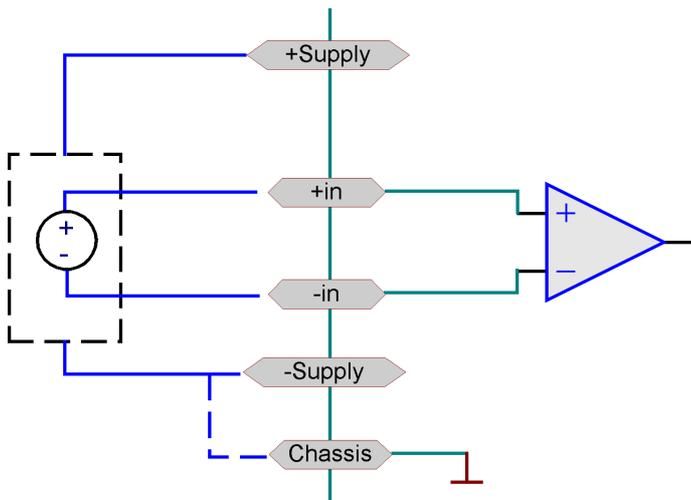
Die Module SCI8, SCI16 und SC16 können optional mit einer Sensorversorgung ausgestattet werden.
