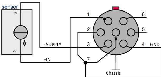
unipolare Versorgung des Sensors 5 V bis 15 V
