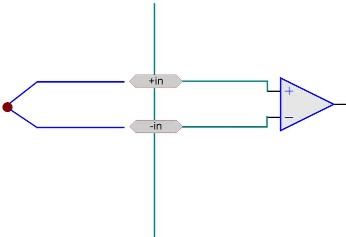
Die gebräuchlichen Typen von Thermoelementen werden durch eine Kennlinienlinearisierung unterstützt. Gebräuchliche Typen von Thermoelementen werden mit ihren charakteristischen Kennlinien unterstützt. Eine Kombination von Thermoelementmessung und PT100 Messung ist möglich.
