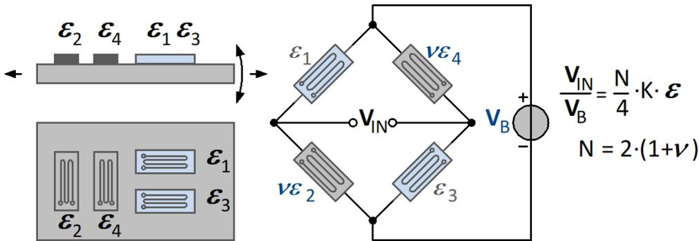
Zwei aktive DMS sind entlang der Hauptdehnung angebracht. Diese werden durch zwei quer angeordnete DMS ergänzt. (**Zugstabarrangement**). In der Brücke liegen die DMS entlang der Hauptrichtung in den gegenüberliegenden Zweigen. Durch diese Schaltung erfolgt eine höhere Ausnutzung der Querkontraktion und Längskraft bei einer guten Temperaturkompensation. In dieser Schaltung ist die Angabe der Querdehnzahl des Materials von Bedeutung. Die Dehnung ergibt sich zu:
