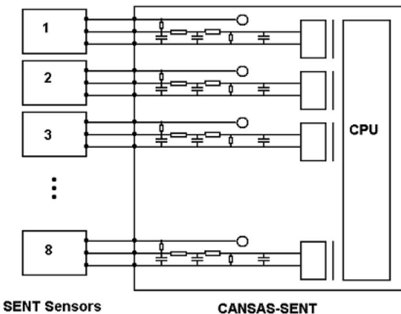
Das Bild oben zeigt die 8fache Anordnung im Standard-Betrieb.
