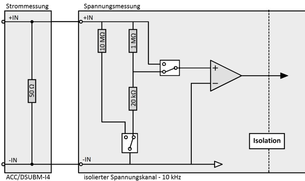
Bei der LEMO Variante erfolgt die Strommessung über einen internen  $50 \Omega$  Shunt. Das Stromsignal wird dazu direkt an die Pins 7 (+I) und 2 (-IN) angeschlossen.
