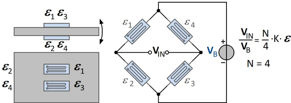
Die Schaltung besteht aus vier aktiven DMS. Zwei von ihnen befinden sich unter Druck und zwei unter gleichgroßem Zug. Die DMS mit der vorzeichengleichen Dehnung befinden sich in den gegenüberliegenden Brückenzeigen. Die Empfindlichkeit des Biegemoments wird erhöht. Gleichzeitig werden Längskraft, Drehmoment und Temperatur kompensiert. Die Dehnung ergibt sich zu:
