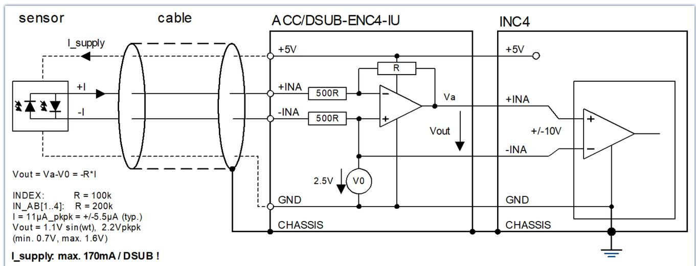
Wird ein Drehgeber verwendet, der mit Stromsignalen arbeitet, kann der Strom/Spannungs-Stecker ACC/DSUBM-ENC4-IU verwendet werden. Es ist möglich, dass der Sensor aus dem INC4-Modul heraus versorgt wird. Dabei gilt: max. Versorgungsstrom: 170 mA pro DSUB-Stecker. Bei höherer Stromaufnahme des Drehgebers muss dieser extern versorgt werden.
