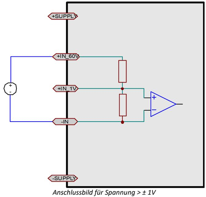
Die differenzielle Eingangsimpedanz für die Spannungsmessung von ±60 V bis ±2 V beträgt 900 kΩ, für die Spannungsmessung von ±1 V bis ±100 mV beträgt sie 5 MΩ. Der Eingang ist DC-gekoppelt. Das differenzielle Verhalten wird durch den isolierten Aufbau erreicht.
