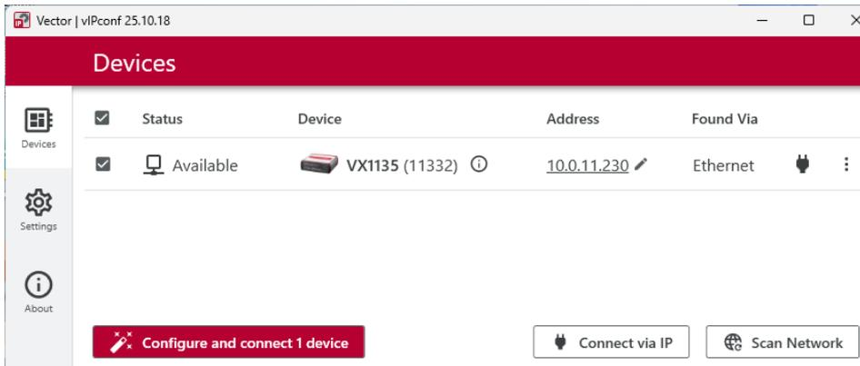
Um die Verbindung zwischen PC und VX1135 Gerät herzustellen, bestätigen Sie den Button "Connect via IP".
