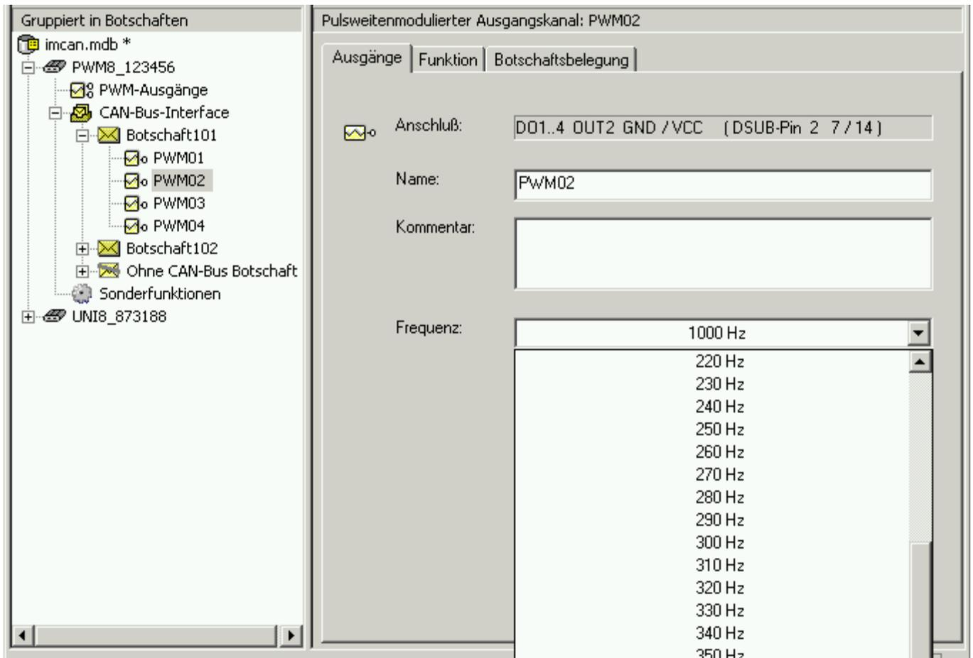
Das Bild zeigt die Konfigurationsoberfläche für den PWM8-Modul. Links ist ein Baumdiagramm unter der Überschrift 'Gruppieren in Botschaften' zu sehen, das die hierarchische Struktur des Moduls zeigt, einschließlich der CAN-Bus-Interface, Botschaften (Botschaft101, Botschaft102) und Sonderfunktionen. Rechts ist die Konfiguration für den 'Pulsweitenmodulierten Ausgangskanal: PWM02' dargestellt. Die Konfiguration umfasst:
