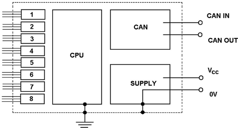
Deutlich ist zu erkennen, dass der CAN-Anschluss und die 8 Eingangsschaltungen (Blöcke 1..8 links im Schaubild) isoliert sind gegen das restliche Modul. Das restliche Modul besteht dabei aus der Versorgungseinheit des Moduls (nicht der Sensoren!), seiner CPU und dem Gehäuse, die alle auf gemeinsamem Potential liegen und eine gemeinsame Masse haben.
