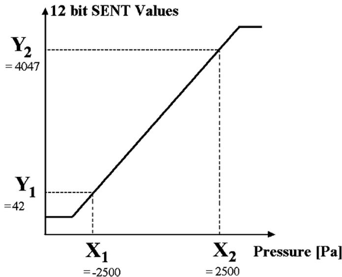
Ein Relativdrucksensor hat diese Kennlinie:
