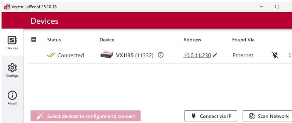
Eine erfolgreich Verbindung zwischen Ihrem PC und dem VX1135 Gerät, wird mit dem Status "Connected" bestätigt.
