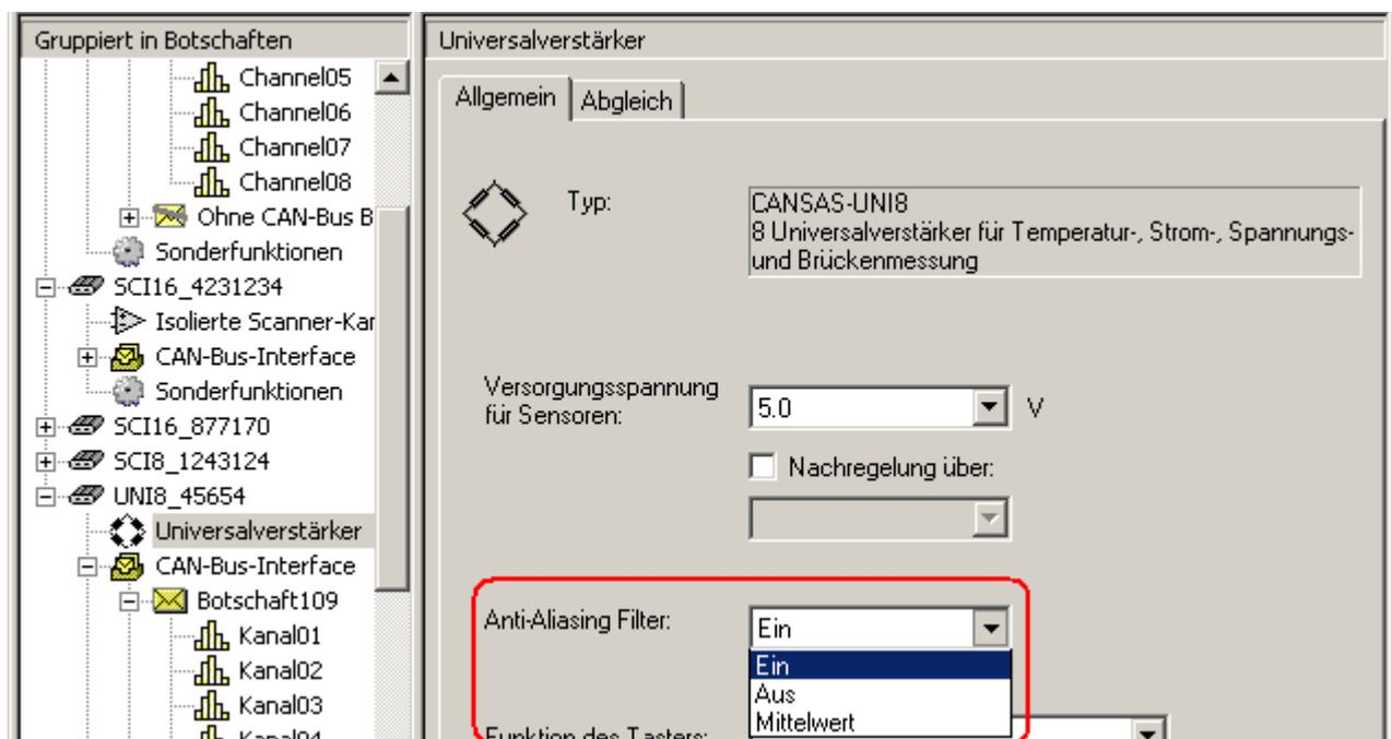
**Ein:** Digitales Tiefpassfilter zusätzlich zum analogen Anti-Aliasing-Filter eingeschaltet.
