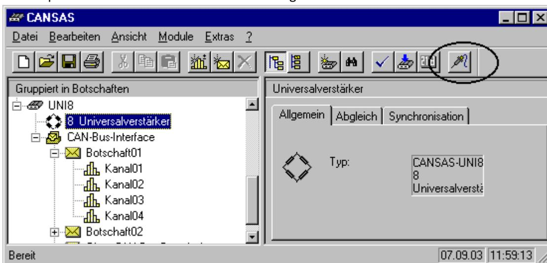
4. Anschließend erscheint ein Dialog, der Details zeigt, an welchen Kanälen Sensoren mit EPROM angeschlossen sind. Außerdem wird gezeigt, wie die Eigenschaften der Sensoren in Einstellungen der Kanäle übertragen werden.
