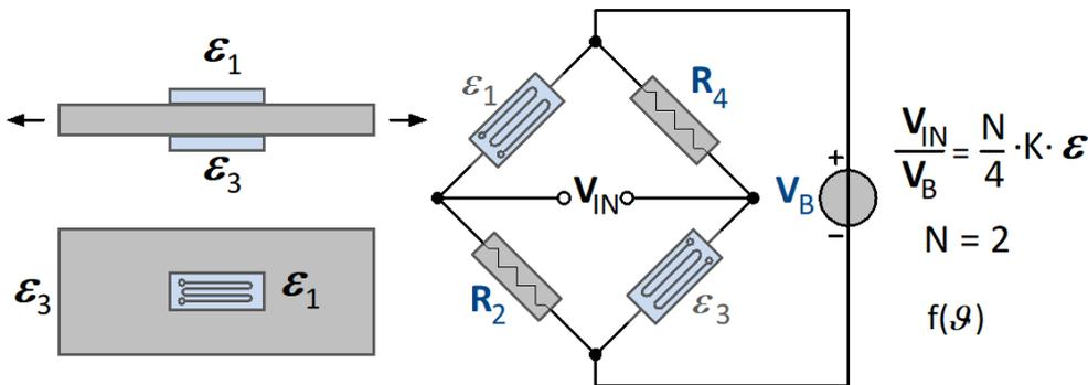
Zwei aktive DMS sind unter gleicher Dehnung und gleichem Vorzeichen angeordnet. Messung von Zug- und Druckkräften (nicht-linear) zur Eliminierung von Biegung. Der Temperaturgradient sollte klein sein. Die Dehnung ergibt sich zu:
