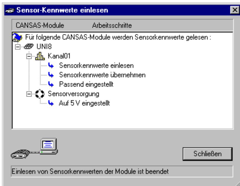
Alternativ zum Drag&Drop kann auch der Sensor in imc SENSORS selektiert werden. Hier wird in der imc CANSAS-Software links im Baum ein oder mehrere Kanäle selektiert und der Menüpunkt *Bearbeiten / Sensor einfügen...* gewählt. Jetzt werden die Eigenschaften des Sensors zur Einstellung aller Kanäle benutzt. Das ist z.B. sinnvoll bei Sensor-Eigenschaften, die pauschal ohne spezielle Seriennummer gelten, z.B. ein einfaches Thermoelement Typ K.
