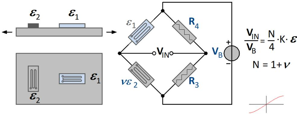
In dieser Schaltung werden zwei **aktive** DMS verwendet. Der zweite DMS wird auf dem Messobjekt quer zur Hauptdehnungsrichtung angeordnet. Es wird die Querkontraktion ausgenutzt. Aus diesem Grund ist neben der Angabe des K-Faktor des DMS auch die Angabe der Querdehnzahl des Materials von Bedeutung. Die Schaltung besitzt eine gute Temperaturkompensation. Die Dehnung berechnet sich:
