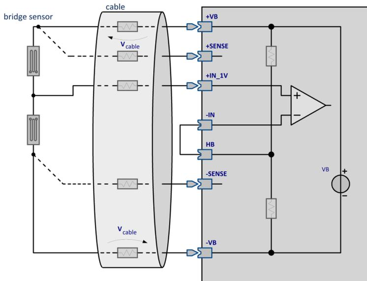
In vielen Anwendungen bildet der Sensor nur die Hälfte der Vollbrücke, also zwei gegenläufig veränderliche Impedanzen. Die andere Hälfte muss mit einem symmetrischen Widerstandsleiter ergänzt werden. Bei dem imc μ-CANSAS-Brückenkanal steht diese Halbbrücken-Ergänzung bereits **intern vorverdrahtet** zur Verfügung. Sie ist an der Anschlussklemme als "HB" herausgeführt und muss nur noch durch eine **Drahtbrücke** mit dem Eingangspin -IN verbunden werden.
