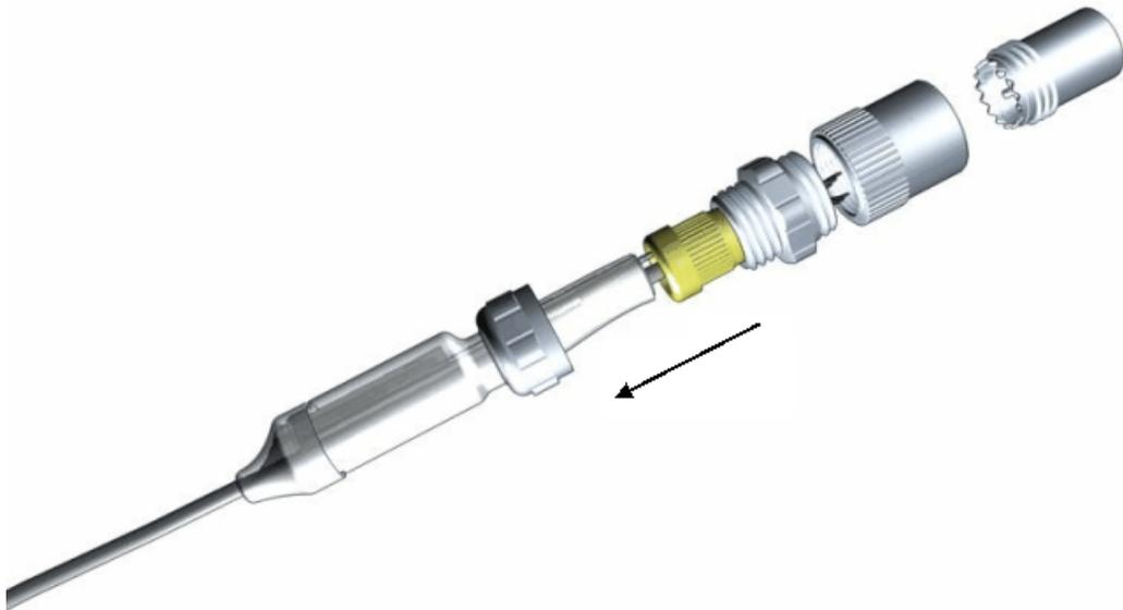
*Die Quetschdichtung wird fest auf den Silikonschlauch gedrückt.*
