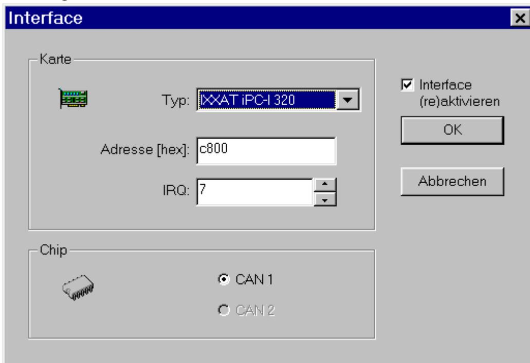
Die folgenden Optionen ermöglichen es anzugeben, welches Interface ausgewählt werden soll und wie diese Schnittstelle zu konfigurieren ist:
