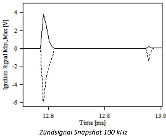
Deutlich ist die Abweichung zwischen Minimum und Maximum zu erkennen. Der wahre Verlauf liegt zwischen den beiden Einhüllenden.
