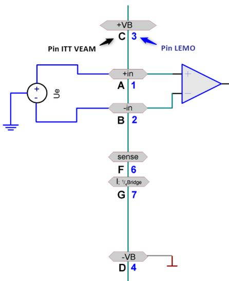
Die Spannungsquelle selbst hat schon einen Bezug zur Masse des Gerät. Die Spannungsquelle muss im Potential gegenüber der Geräte-Masse festgelegt sein.
