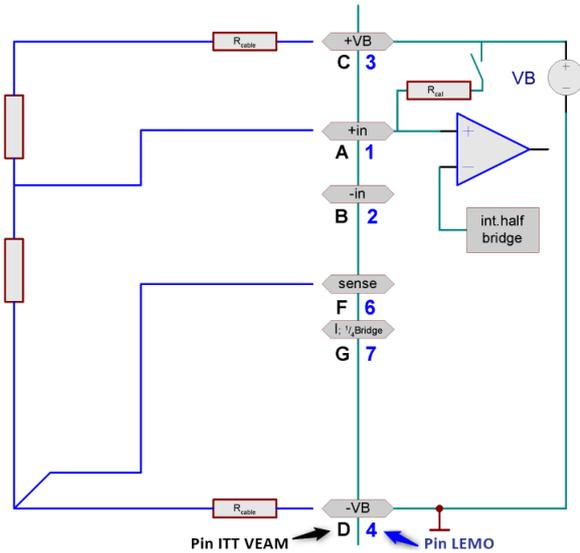
Sie haben nur eine Halbbrücke. Das können z.B. zwei zusammen geschaltete DMS sein oder ein Sensor, der intern eine Halbbrücke ist, oder ein potentiometrischer Sensor. Die Halbbrücke wird 4-drahtig angeschlossen. Zur Wirkung und Nutzung der Senseleitung SENSE, siehe Beschreibung der [Vollbrücke](#) <sup>376</sup>.
