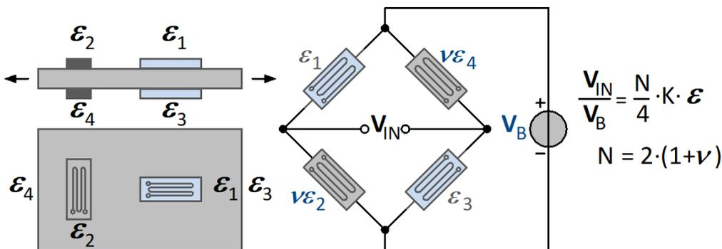
Vollbrücke mit vier aktiven DMS. Zwei aktive DMS sind durch zwei quer angeordnete Poisson'sche DMS ergänzt. Sie befinden sich in den benachbarten Brückenzweigen. Geeignet für Zug/Druckmessung, kompensiert Biegung, Torsion und Temperatur.
