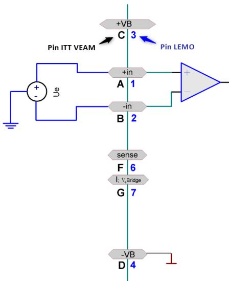
Die Spannungsquelle selbst hat schon einen Bezug zur Masse des Gerätes. Die Spannungsquelle muss im Potential gegenüber der Gerätemasse festgelegt sein.
