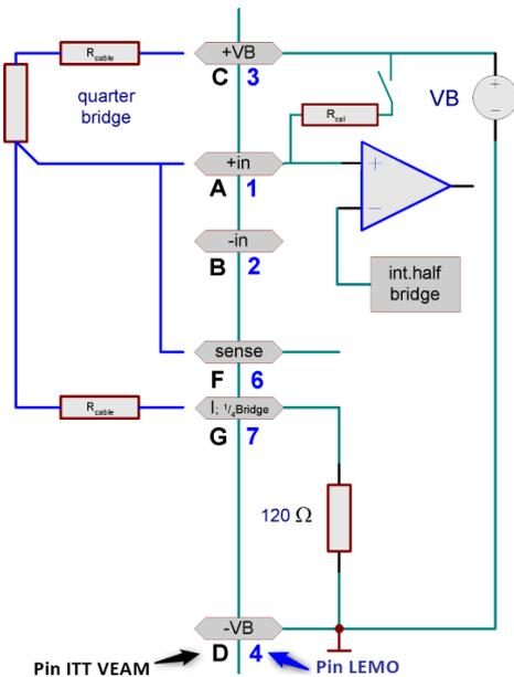
Eine Viertelbrücke kann ein einziger DMS oder ein Widerstand mit einem Nennwert von 120 Ω oder 350 Ω sein. Bei einer Viertelbrückenmessung kann nur eine 5 V Brückenversorgung gewählt werden.
