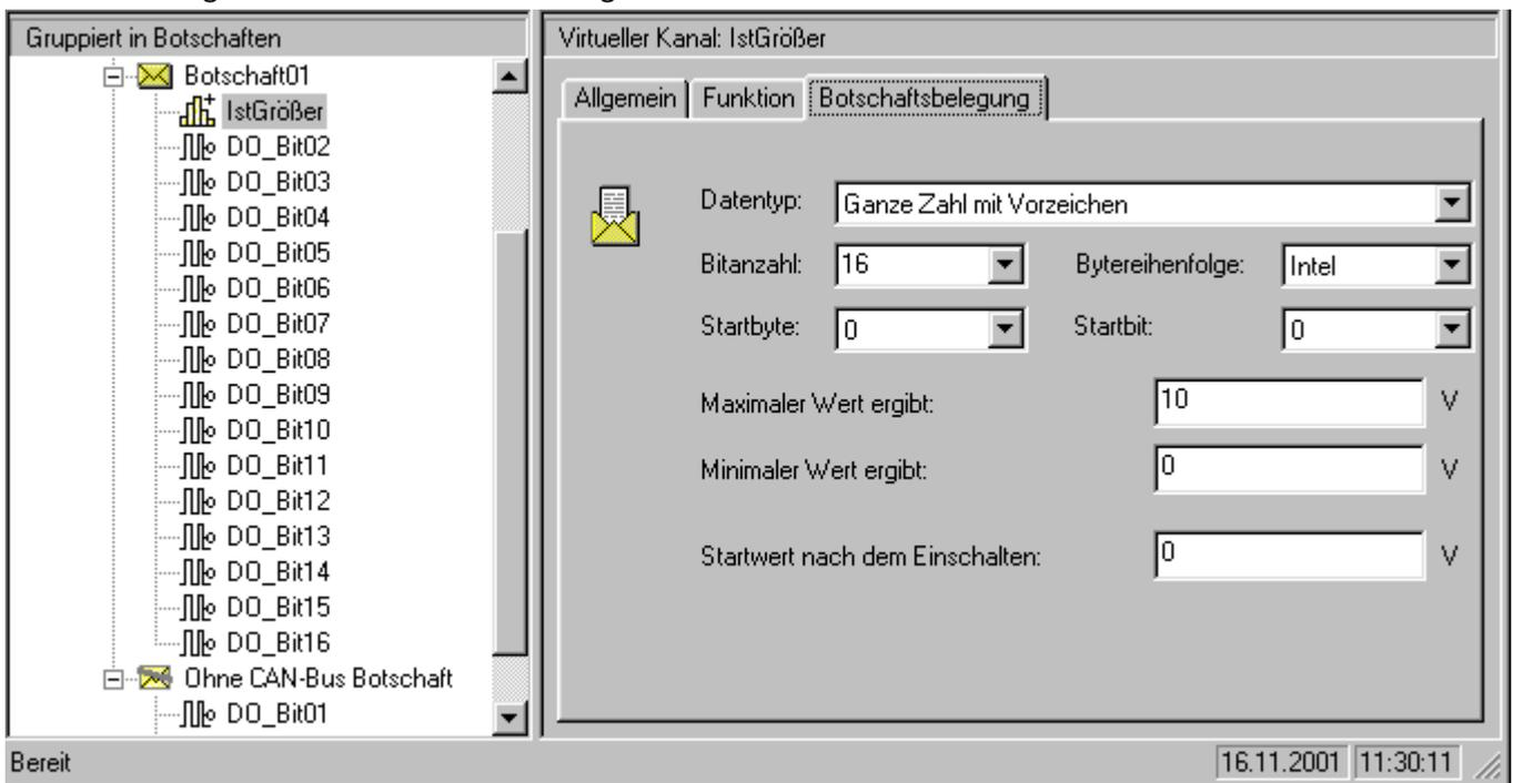
In diesem Beispiel wird eine 16Bit Messgröße vom CAN-Bus gelesen, die so skaliert ist, dass ihr Minimum 0V ist und ihr Maximum 10V. Die Einheit steht hier immer auf "V". Das Modul beachtet die Einheit nicht. Es macht also nichts, wenn eine Drehzahl eingelesen wird, die von 0 (Null) bis 6000U/min skaliert ist und nicht bis 6000V.
