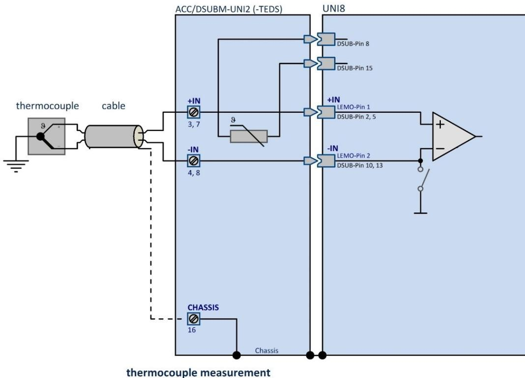
Wenn das Erdpotential am Thermoelement um einige Volt gegenüber dem am Modul verschoben sein sollte, wird diese Spannung durch den differentiellen Messeingang unterdrückt und wirkt sich nicht als Störung aus. Die maximal zulässige Gleichtaktspannung darf jedoch nicht überschritten werden.
