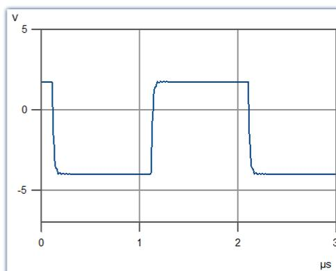
Reflexionen an Leitungsabzweigen können durch möglichst geringe Stichleitungslängen minimiert werden. Mit einer an beiden Enden abgeschlossenen Linientopologie kann somit das bestmögliche Produkt aus Übertragungsrate und Busleitungslänge erzielt werden.
