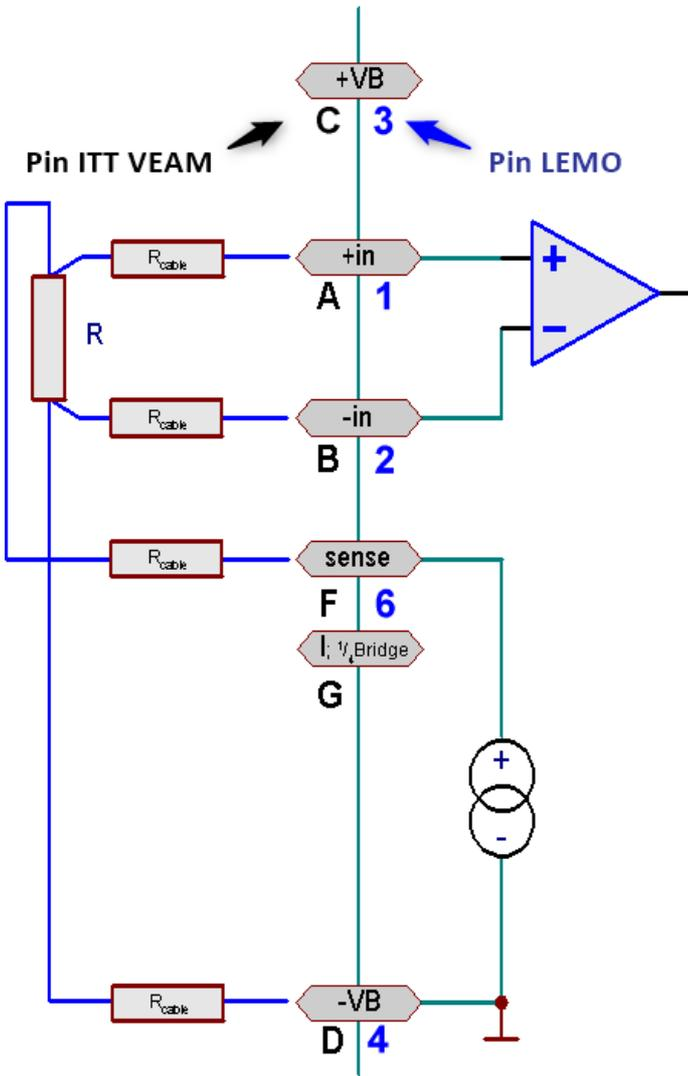
Es gibt für die Widerstandsmessung einen einzigen Bereich: 0  $\Omega$  bis 800  $\Omega$ . Jeder Widerstand wird aus einer eigenen Stromquelle mit ca. 1,2 mA gespeist. Die Messung erfolgt in Vierleitertechnik.
