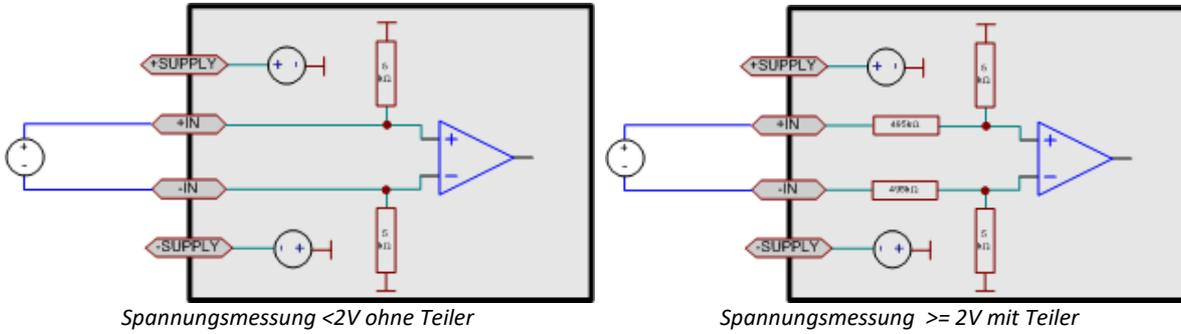
Die Spannungsquelle selbst hat schon einen Bezug zur Masse des imc CANSAS-Moduls. Die Spannungsquelle darf im Potential gegenüber der imc CANSAS-Masse nicht frei schweben.
