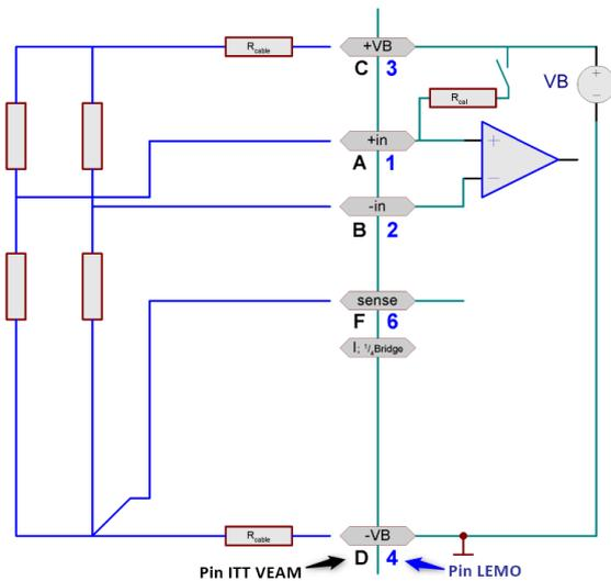
Sie haben eine Vollbrücke, bestehend aus vier Widerständen. Das können vier entsprechend geschaltete DMS sein oder auch ein fertiger Sensor, der eine interne Vollbrücke enthält.
