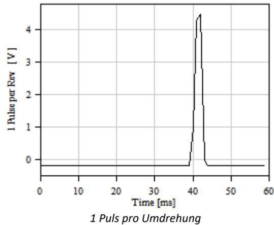
Auch kann ein Inkrementalgeber mit zusätzlichem Null-Ausgang benutzt werden. Der zusätzliche Null-Ausgang wird als Referenz-Signal (REF) an das imc CANSAS-IGN angeschlossen. Der Null-Ausgang gibt dann die Null-Markierung auf der Kurbelwelle an.
