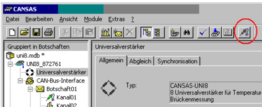
Die Sensorinformationen werden ausgelesen und zur Konfiguration der Kanäle verwendet. Kanäle mit TEDS werden mit einem Symbol gekennzeichnet.
