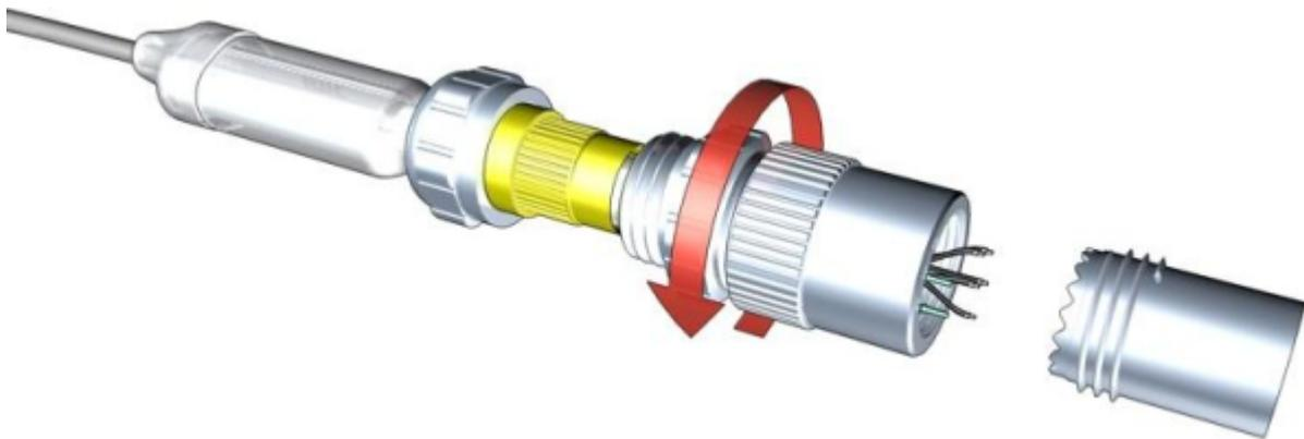
*Die beiden Verbinder miteinander verschrauben und dicht an die Quetschdichtung heranführen.*
