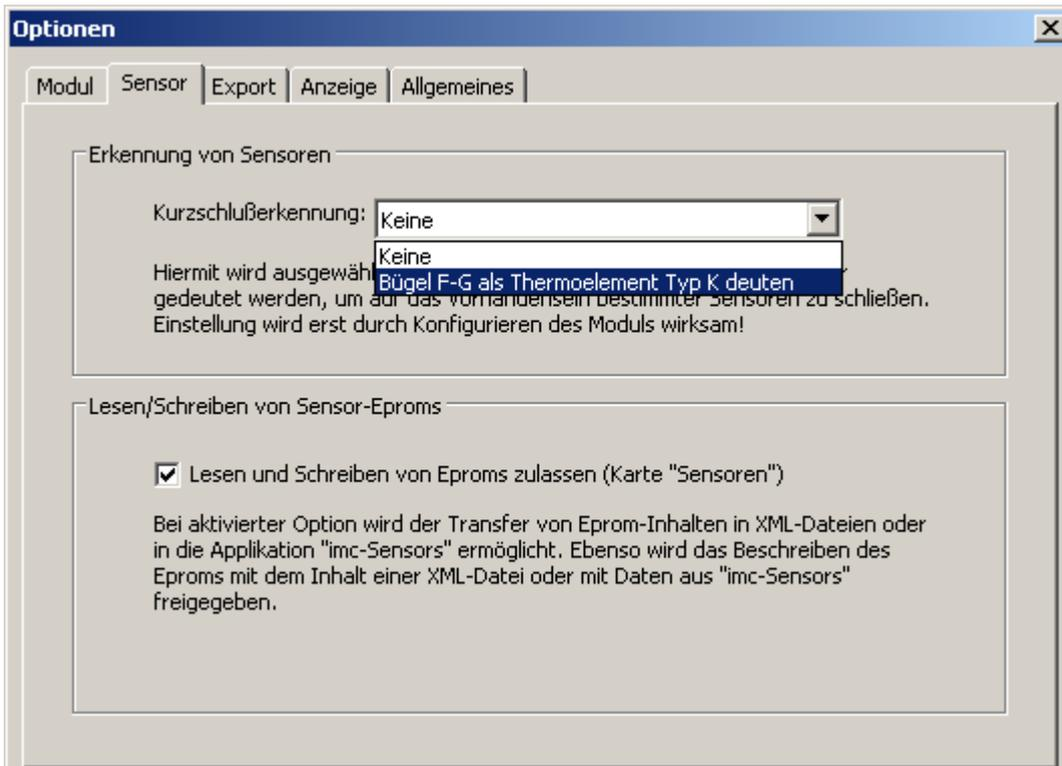
**Erkennung von Sensoren:** Eine Brücke von F nach G kann als Erkennung für Thermoelemente vom Typ-K genutzt werden. Hier wird die Erkennung zugelassen.
