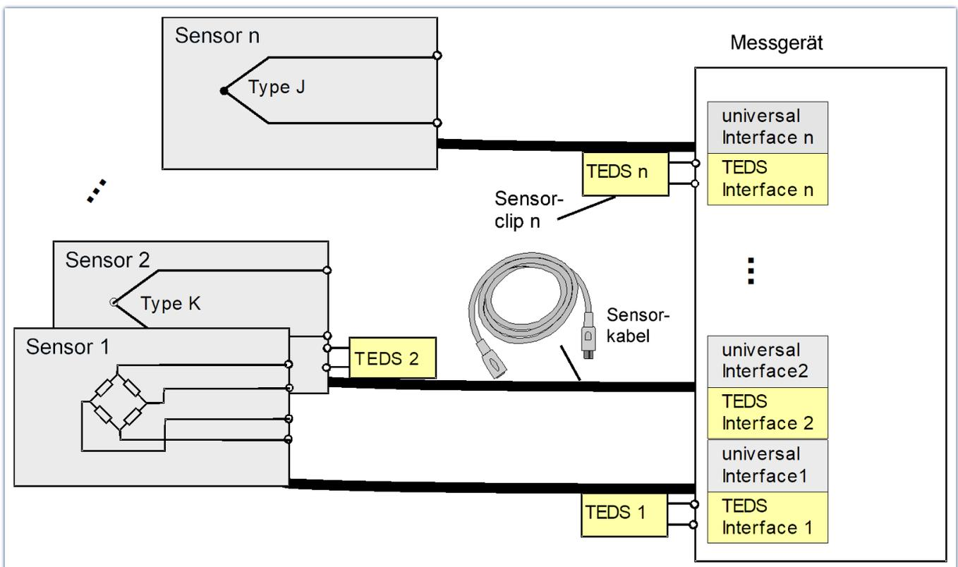
*Sensorik mit frei zum Sensor zuordenbaren TEDS. Das Messgerät besteht aus n universellen Sensorinterfaces. Die nachrüstbaren TEDS können sowohl am Sensor (TEDS 2) oder am Messgerät angeschlossen werden. Die Messkanäle sind für nahezu beliebige Sensoren geeignet, so dass die Sensoren an beliebige, freie Messeingänge angeschlossen werden können.*
