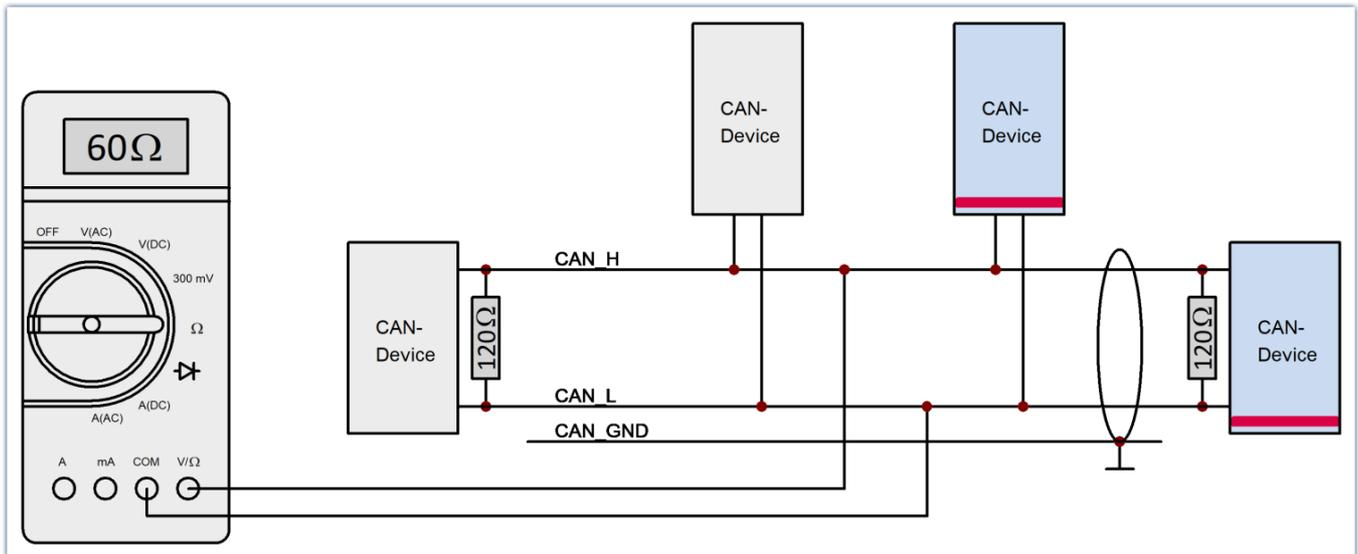
Um Messungen am CAN-Bus z.B. in einem Fahrzeug durchführen zu können, müssen Sie sich Zugang zum Potentialverteiler verschaffen.
