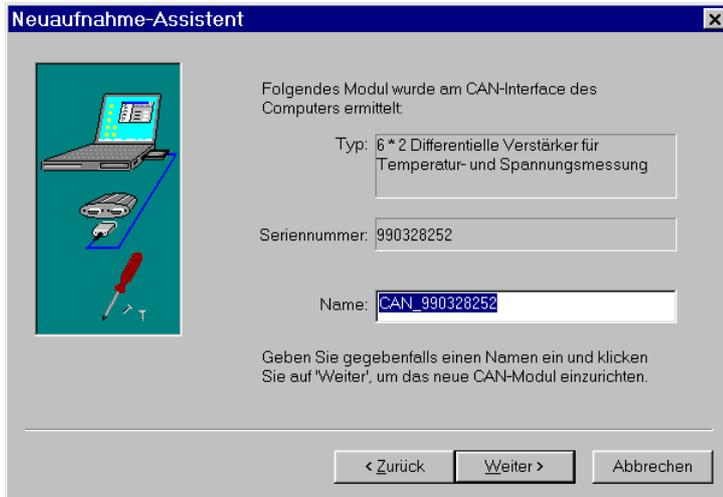
**Typ:** Gibt den Typ des imc CANSAS-Moduls an, z.B. *6 \* 2 Differentielle Eingangskanäle*.
