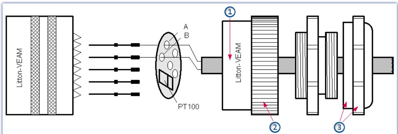
1. Thermokabel durch Mittelstück (②) und Zugentlastung (③) des ITT VEAM Steckers durchführen.
