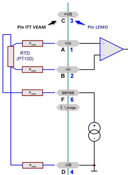
Der PT100 wird über zwei Leitungen (-SENSE und -VB) mit konstantem Strom versorgt. Über zwei weitere Leitungen (+IN und -IN) wird nur die Spannung über dem Sensorelement erfasst. Der Spannungsabfall entlang der stromführenden Leiter verursacht damit keinen Messfehler. Die 4-Leiterschaltung ist die präziseste Technik, den PT100 zu messen.
