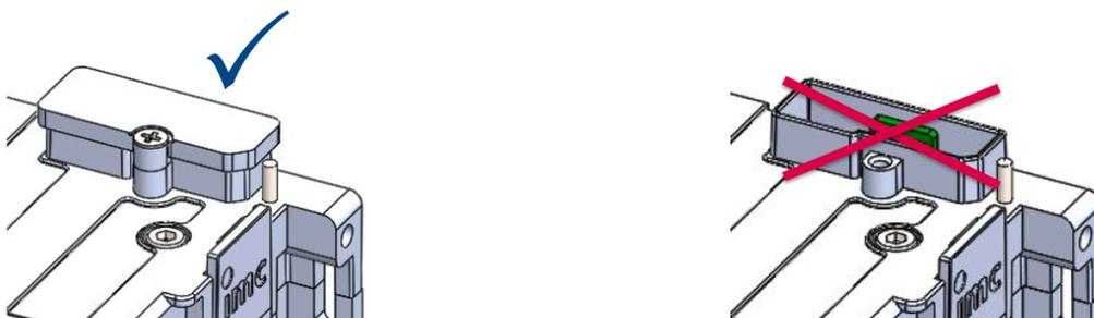
Zur Wahrung des Schutzgrads ist die Montage eines Gesamtsystems aus mehreren Modulen in kontrollierter Umgebung durchzuführen (z.B. auch Dichtungskappe für Klickverbinder).
