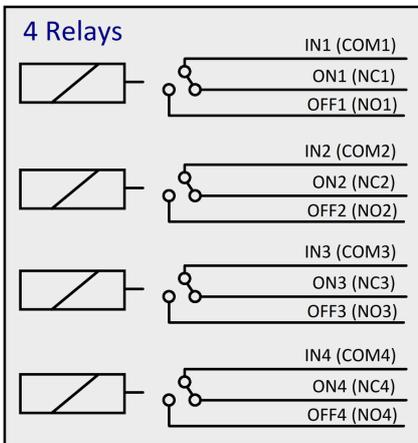
Je nach logischem Signalzustand wird der Kontakt "IN" mit "ON" oder "OFF" verbunden. Dieser Signalpfad ist potentialfrei und kann mit Signalen in beliebiger Stromrichtung und mit Kontakt-Leistungen von bis zu 0.3 A bei 125 V AC bzw. 1 A bei 30 V DC betrieben werden.
