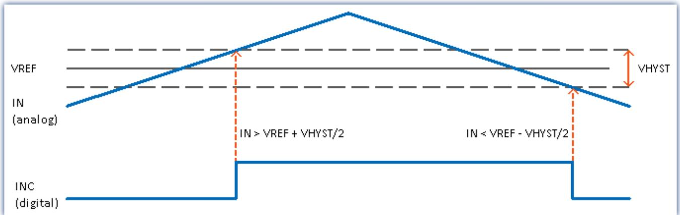
Das *digitale Signal* wechselt von **0 nach 1**, wenn das *analoge Signal* die Schwelle  $V_{REF} + \frac{V_{HYST}}{2}$  überschreitet. Das *digitale Signal* wechselt von **1 nach 0**, wenn das *analoge Signal* die Schwelle  $V_{REF} - \frac{V_{HYST}}{2}$  unterschreitet. Der Betrag der Hysterese stellt somit die Breite eines Bandes dar, das Signalrauschen und Störungen überschreiten dürfen, ohne zu Fehlimpulsen zu führen.
