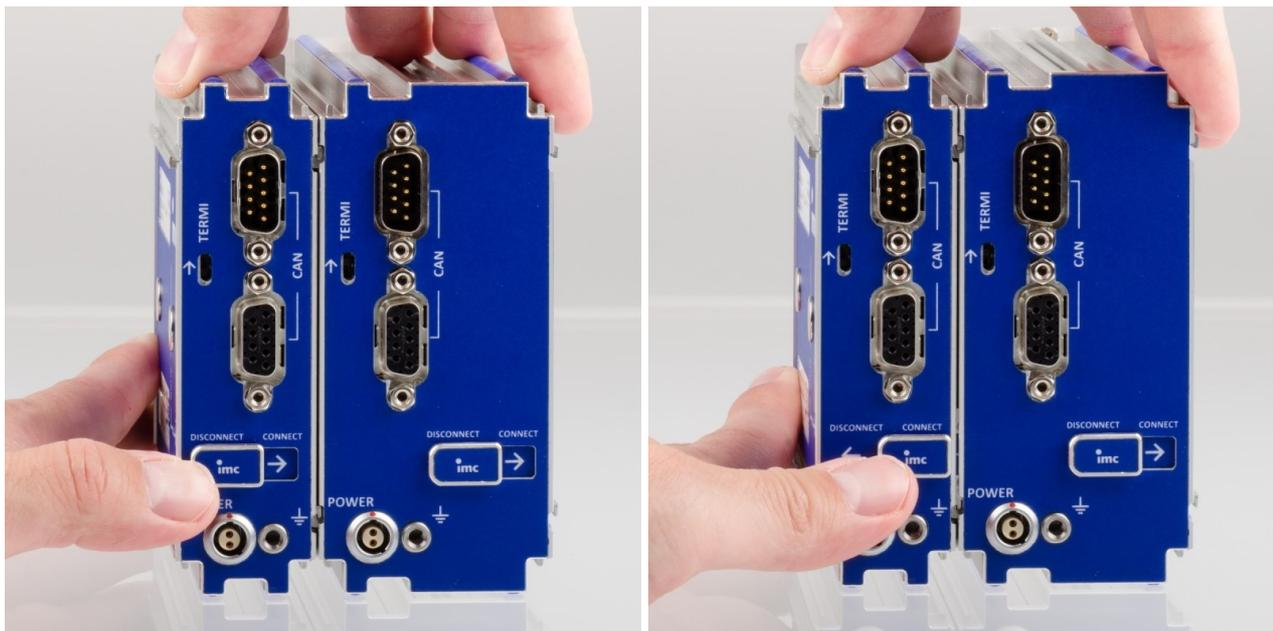
3. Schieben Sie den Verriegelungs-Schieber in die "**CONNECT**"-Position. Die Module sind jetzt elektrisch verbunden und mechanisch gesichert. Um die Module wieder voneinander zu trennen, schieben Sie den Verriegelungs-Schieber in die "**DISCONNECT**"-Position.
