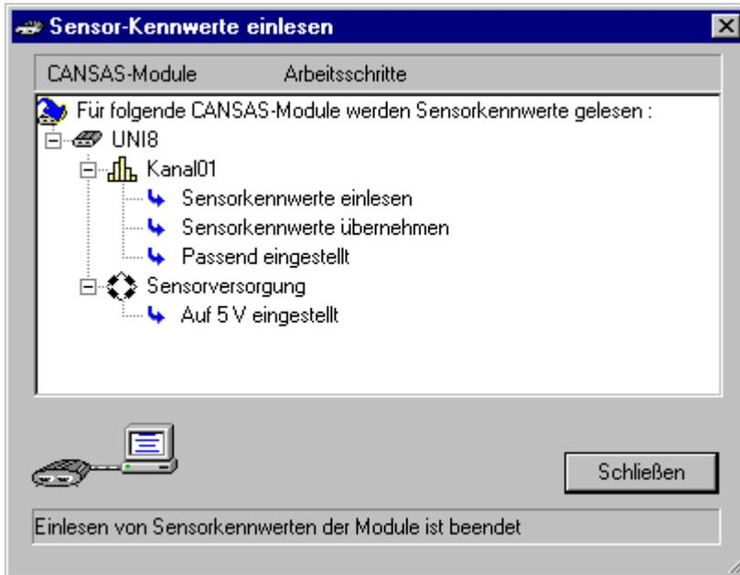
5. Daraufhin können Sie die vorgeschlagene Einstellung der Messkanäle und auch die globalen Moduleinstellungen wie z.B. die Sensorspeisespannung überprüfen und ggf. noch selbst anpassen. Vor allem auch die Datenraten und Kanalnamen sind zu überprüfen.
