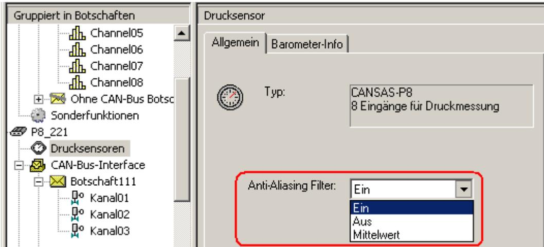
**Ein:** Digitales Tiefpassfilter zusätzlich zum analogen Anti-Aliasing-Filter eingeschaltet.
