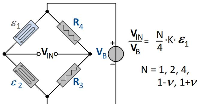
Frei konfigurierbare Halbbrückenschaltung mit Brückenergänzung im Messgerät. N muss aus einer Liste ausgewählt werden.
