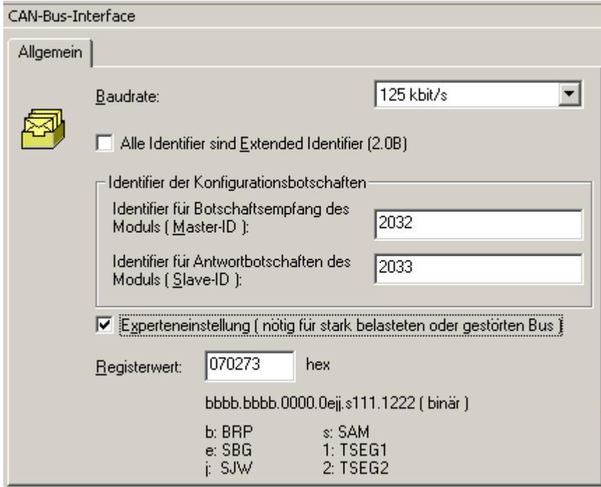
Der Registerwert ist als sechsstellige hexadezimale Zahl einzugeben. Dabei entsprechen die ersten zwei Stellen den untersten 8Bit des "Bit Configuration Register 2" des Tms320F243. Die restlichen vier Stellen entsprechen dem "Bit Configuration Register 1".
