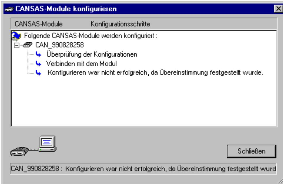
4. Falls sich die Konfiguration des imc CANSAS-Moduls nicht geändert hat und deshalb beim Konfigurieren die oben gezeigte Aufschrift kommt, wählen Sie nochmals den Menüpunkt *Modul / Konfigurieren...*, halten aber die *UMSCHALTEN-Taste (shift)* gedrückt.
