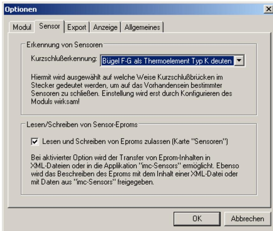
Das UNI8 wird ein angeschlossenes Typ-K Thermoelement in der Konfiguration eintragen.
