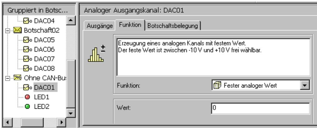
Funktionskarte eines analogen Ausgangssignals, das in keiner CAN-Botschaft enthalten ist
