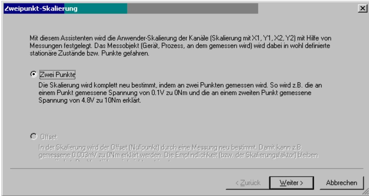
Die Skalierung erfolgt durch die Messung zweier Punkte. Der Anwender trägt die Einheit und die zu erwartenden physikalischen Messwerte ein. Die beiden Punkte werden nacheinander gemessen und mit den Schaltflächen *Messpunkt 1!* bzw. *Messpunkt 2!* übernommen.
