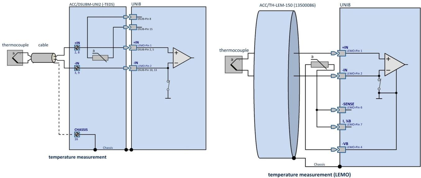
Wählen Sie in der CANSAS Bediensoftware den Messmodus "**Thermoelement (ohne Massebezug montiert)**" aus.
