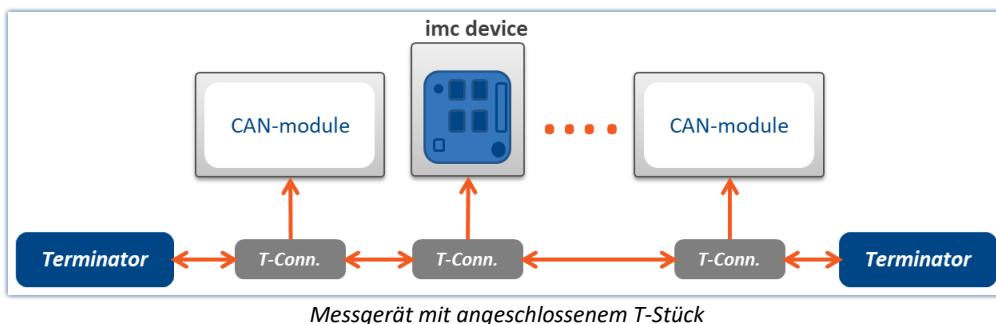
Beachten Sie, dass bei 1 Mbit/s Übertragungsrate am CAN-Bus die **Stich-Leitung** an einer T-Verbindung **nur maximal 30 cm lang** sein darf.
