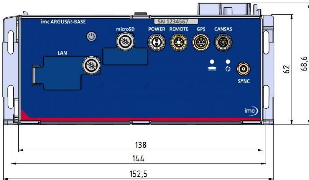
Abb. 12: Abmessungen, extra breites XW-Gehäuse: gilt für Basiseinheit und USV
