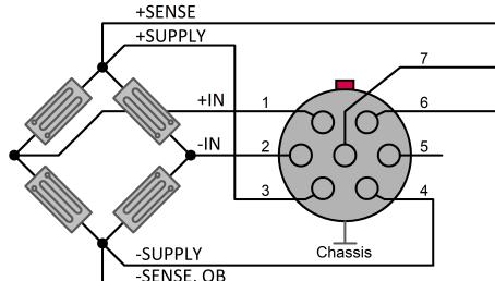
Abb. 31: Anschlußschema B-4 Vollbrücke
