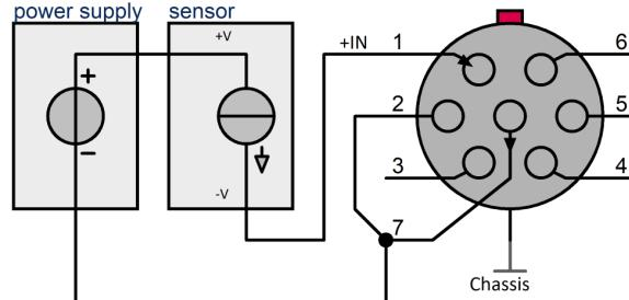
Abb. 36: Strommessung II (UTI-6)
