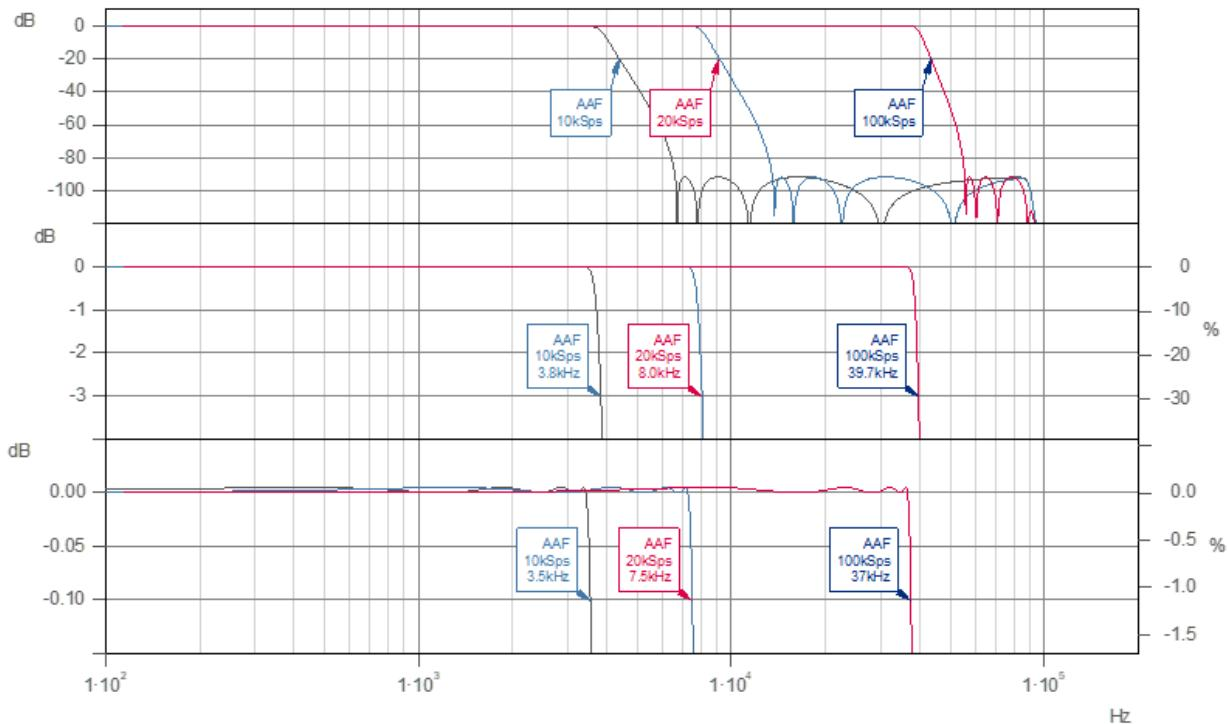
Abb. 20: "Filter-Typ: AAF" (Cauer) für verschiedene Grenzfrequenzen ( $f_s$  prim = 200 kSps)
