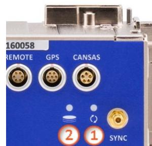
Abb. 10: LEDs der ARGFT-BASE
