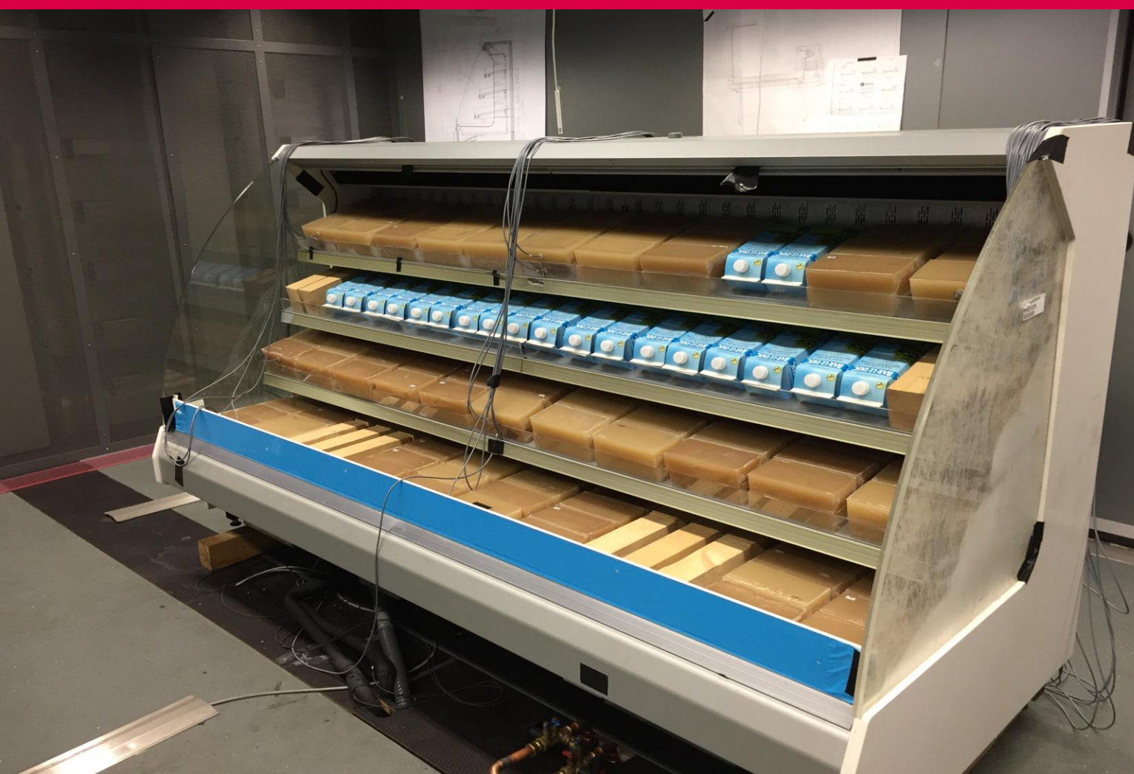
图 1 : Smeva 制冷单元包含用于温度测试的模拟产品
