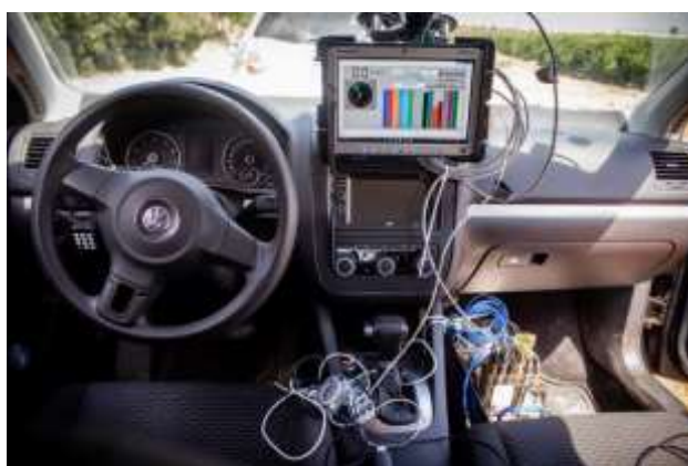
图 4: 车内配备 imc STUDIO 应用程序的平板电脑 ©MotionTech
