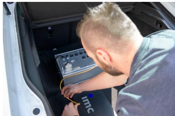
Abb. 2: Anschließen an CAN-Bus und WLAN
